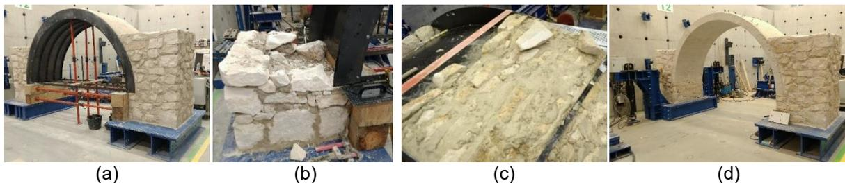
**Figura 2. Construcción del modelo experimental. (a) cimbra constructiva, (b) muros, (c) bóveda y (d) modelo experimental concluido**
