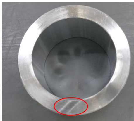
Figura 11 - Peça manchada por conta do seu armazenamento em caixa
