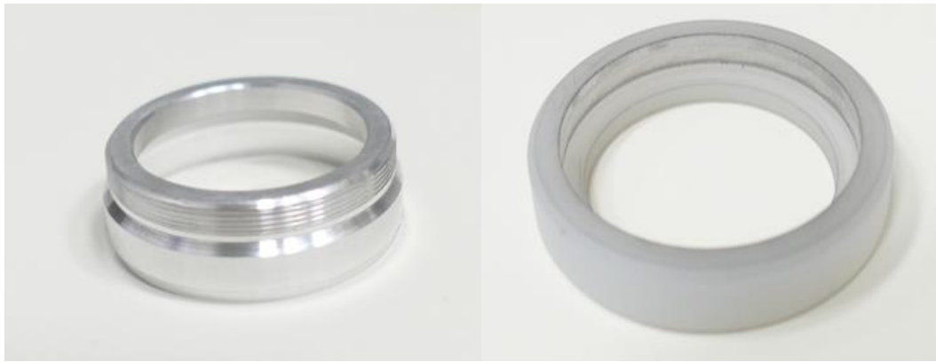
Figura 14 - Objeto de estudo e mecanismo de proteção da rosca utilizado
