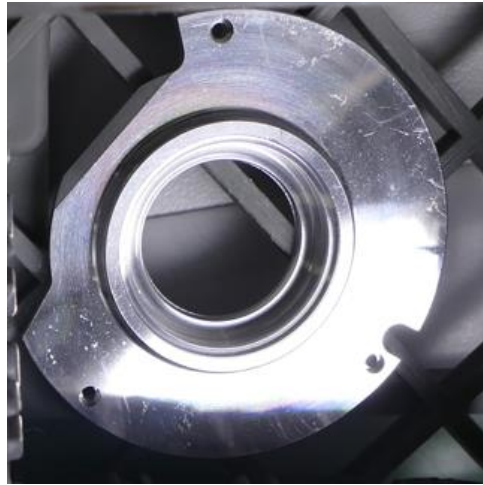
Figura 12 - Peça com várias indentações na sua superfície
