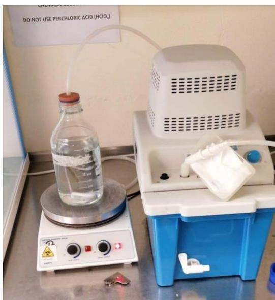
**Figura 19** - *Desgaseificador de eluentes.*
