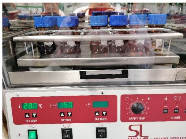
**Figura 20** - Ensaio de adsorção de fármacos em matriz de efluente.
