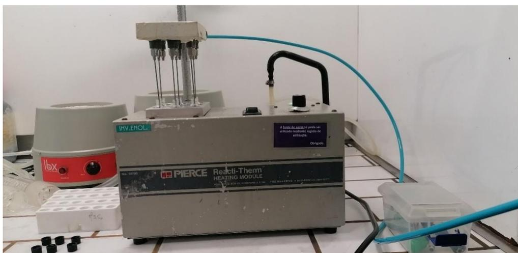
**Figura 18** - Sistema de evaporação com azoto.
