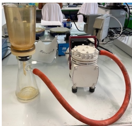
Figura 14. Sistema utilizado na filtração a vácuo.
