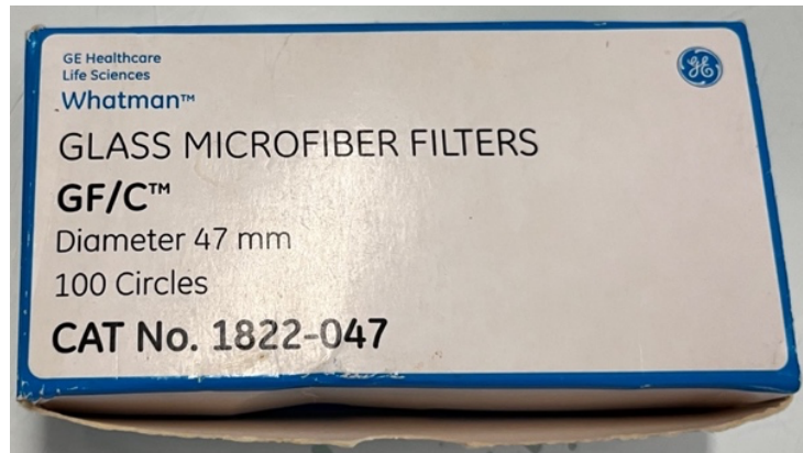
Figura D. 18. Caixa dos filtros utilizados na filtração a vácuo.
