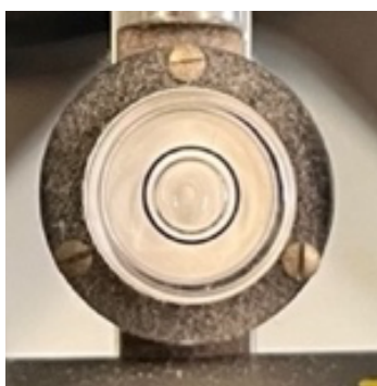
Figura 17. Ângulo e inclinação do viscosímetro ajustados.
