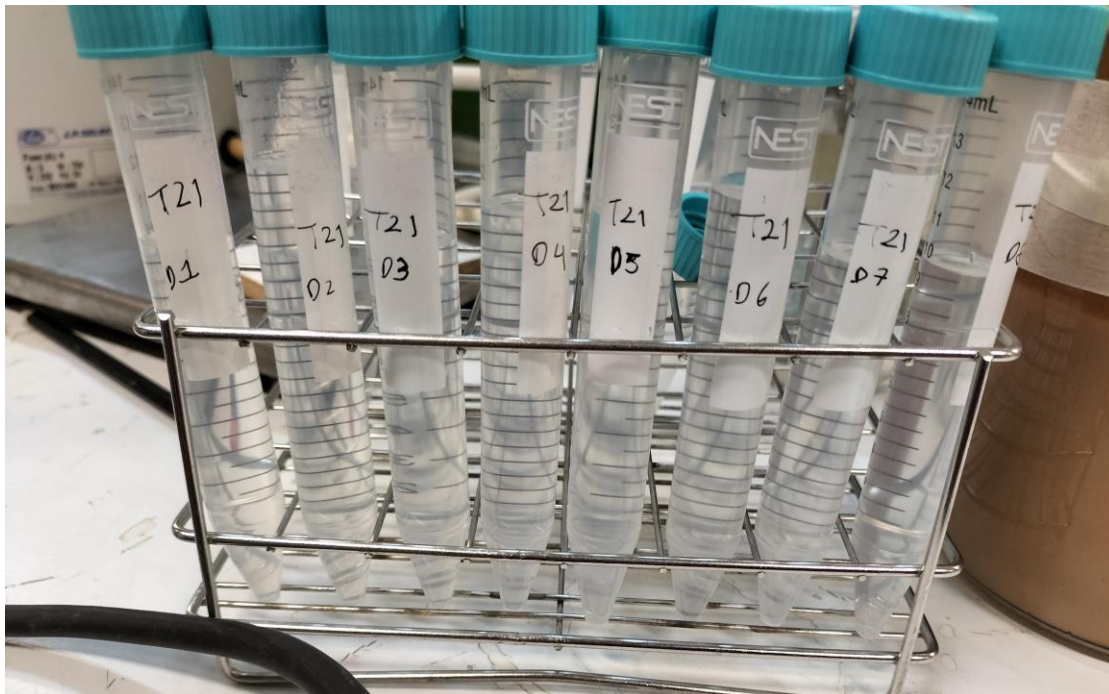
Figura 21. Falcons com as 14 frações de aproximadamente 10 mL de destilação de etanol.
