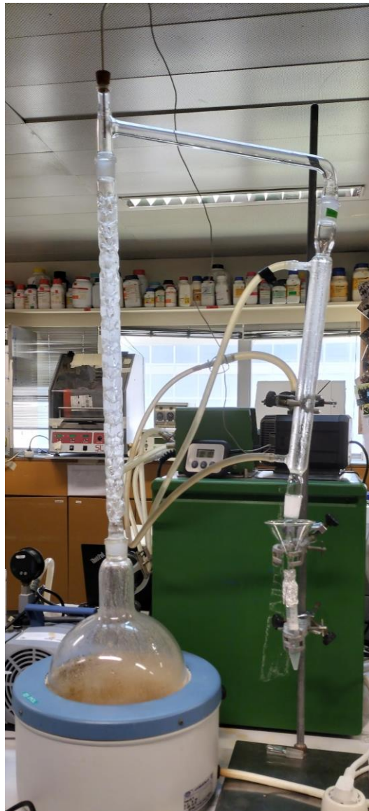
Figura 8. Sistema de destilação da solução obtida pela fermentação.
