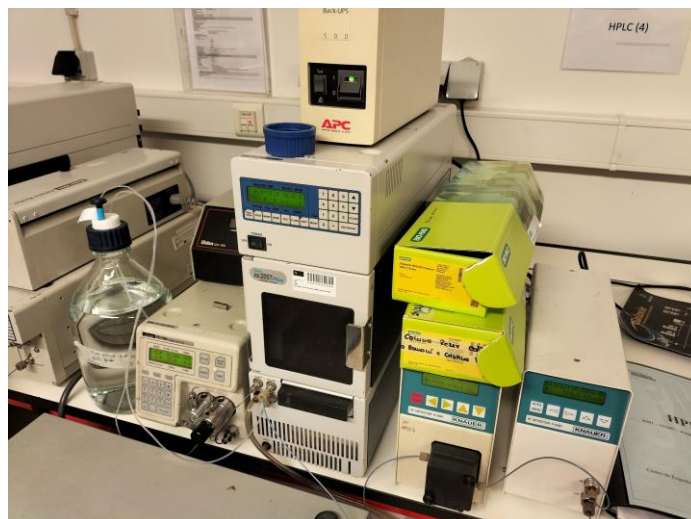
Figura 15. Cromatógrafo de HPLC, com (da esquerda para a direita) uma bomba isocrática, autosampler, coluna de troca iônica e detetores UV e RI.
