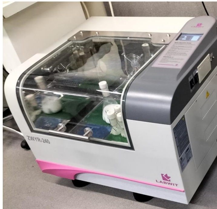
Figura 6. Exemplo de uma incubadora onde se irá realizar o crescimento das S.cerevisiae .
