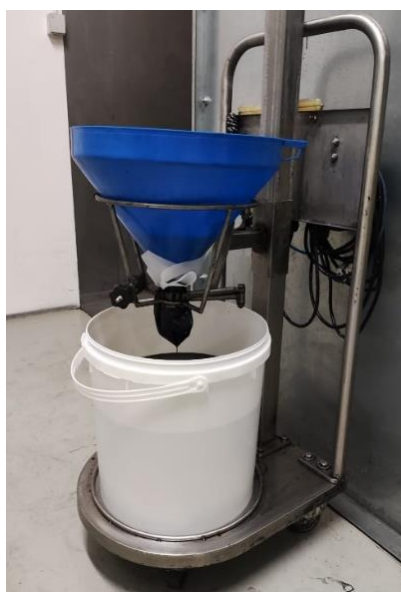
Figura 36. Processo de filtração das tintas
