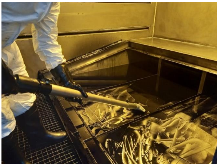
Figura 35. Recolha do overspray depositado na tina de retenção da cabine de pintura
