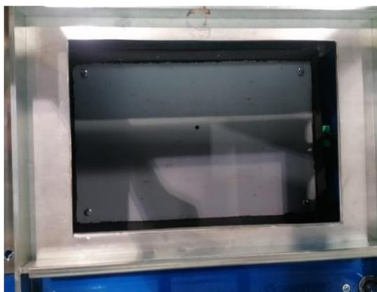
Figura 18. Suporte de fixação do filme.
