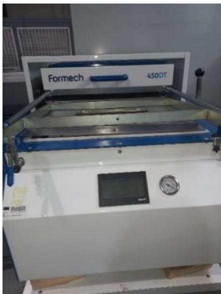
Figura 16. Equipamento utilizado na termoformação.
