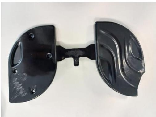
Figura 49. Diferenças de enchimento das peças moldadas.
