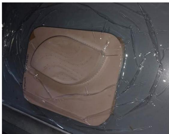
Figura 27. Filme termoformado com 0.5 bar, resistências a 100% e 32 s.
