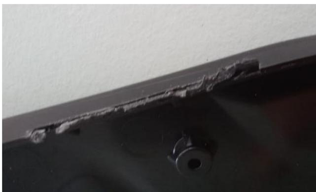
Figura 51. Fratura da peça provocada pela remoção do canal de alimentação.
