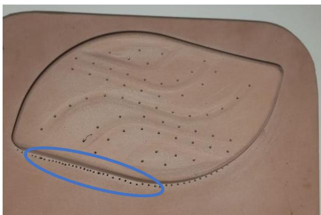
Figura 26. Molde de termoformação.
