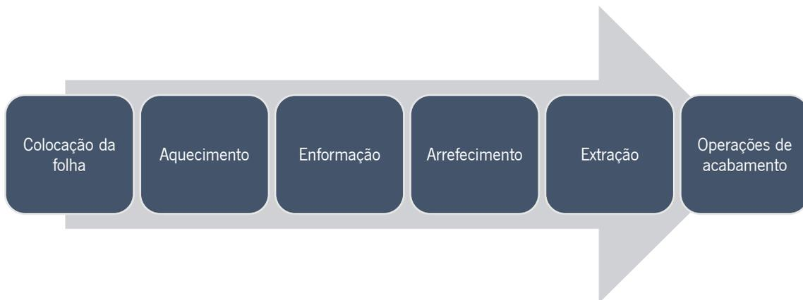
Figura 4. Etapas do processo de termoformação
