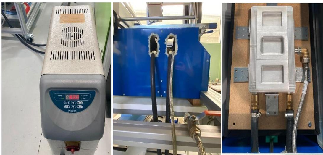
Figura 22. Ligação do termostato à placa de aquecimento
