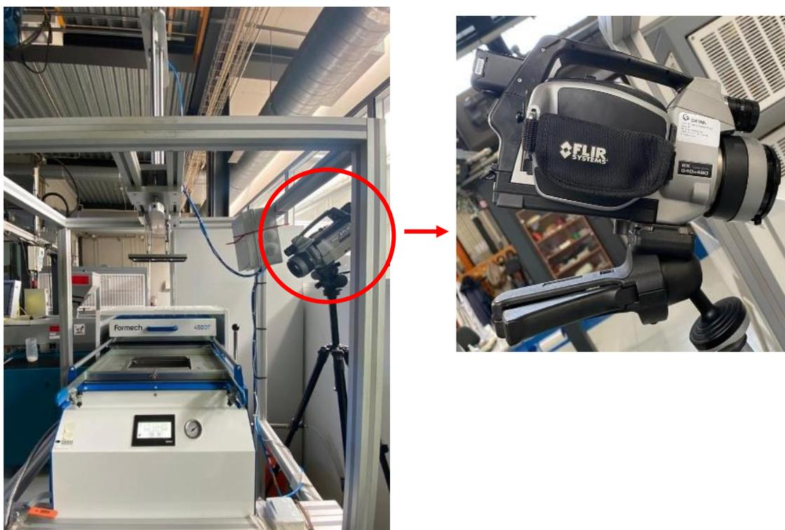
Figura 33. Câmara IR ThermoCAM SC640
