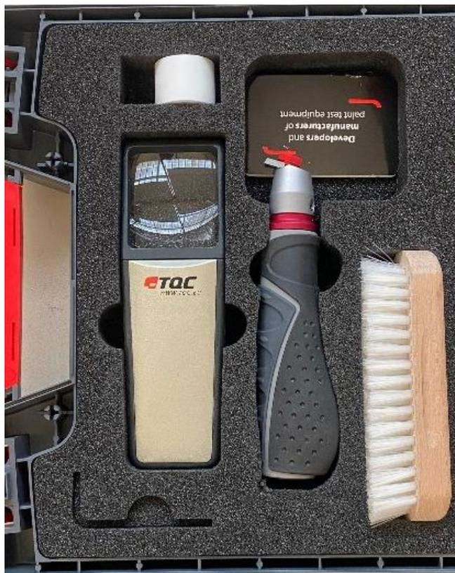
Figura 26. KIT de Teste de Adesão Cross Cut TQC CC2000
