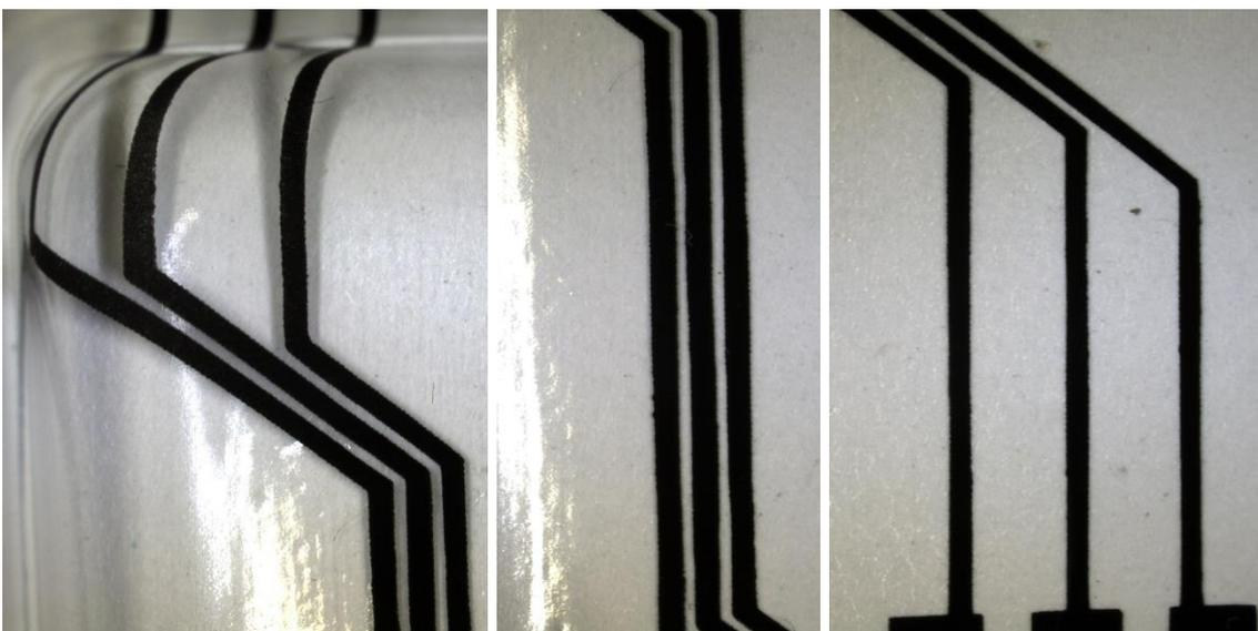
Figura 59. Estado das linhas de carbono em peças com profundidade de 10 mm
