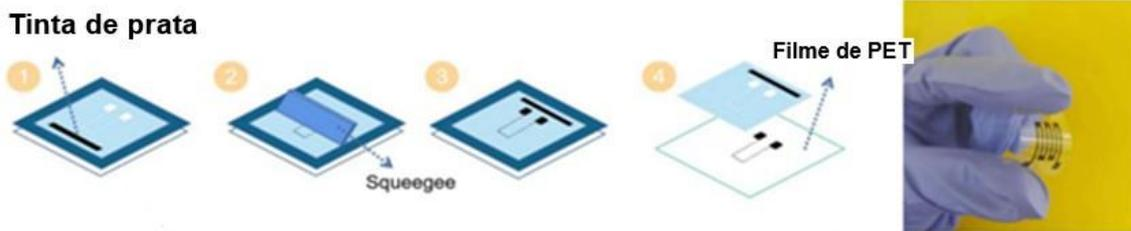
Figura 3. Processo de serigrafia adaptado de [5]
