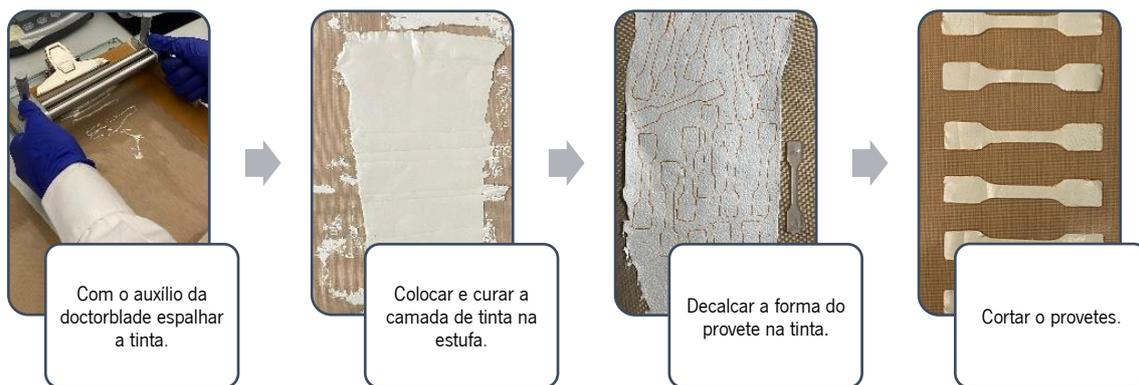
Figura 31. Processo da formação dos provetes de tinta
