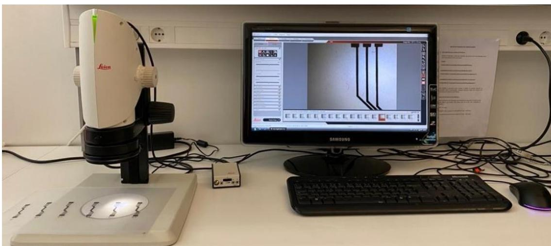
Figura 35. Lupa estereoscópica e respetivo software
