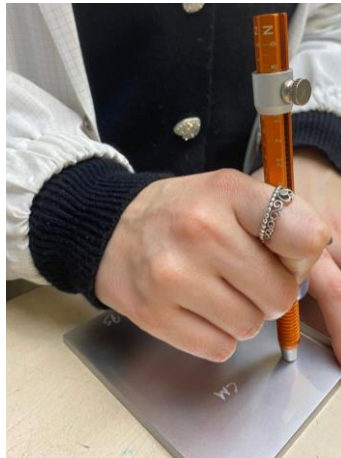
Figura 38. Teste da resistência ao risco.
