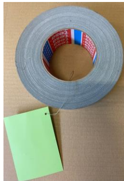
Figura 35. Fita-adesiva Tesa usada no teste Crosscut de acordo com a norma TL226
