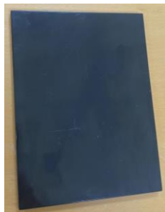
Figura 12. Placa de teste com 110x90x3mm
