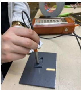
Figura 30. Medição das espessuras.
