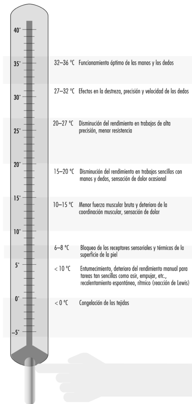
Figura 8. Níveis de temperatura (mãos e dedos) e os impactos na destreza manual. Fonte: Vogt (2001).
