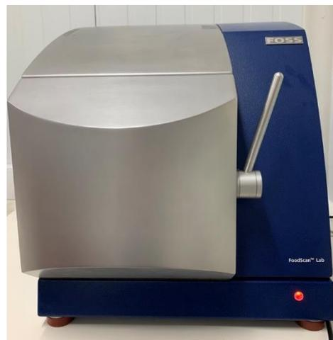
**4.º Passo:** Após se carregar no botão “*Collect*”, o equipamento emite a luz vermelha no canto inferior direito e após 50 s obtém-se os resultados dos 4 parâmetros nutricionais.
