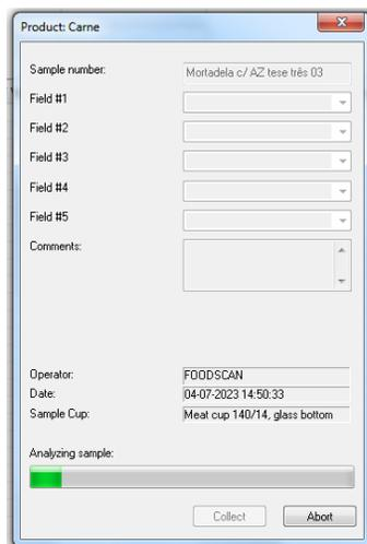
**3.º Passo:** Preencher o campo “*Sample number*” com o nome da amostra a analisar e carregar no botão “*Collect*”, para se iniciar a leitura da amostra.
