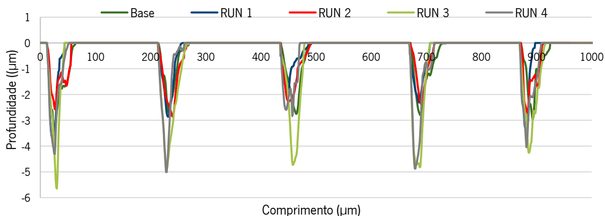
Figura 56. Curva morfológica das linhas de soldadura
