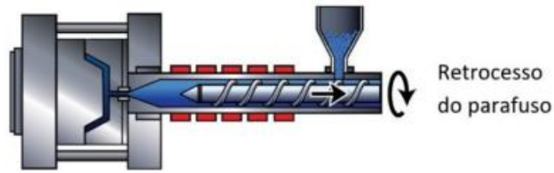
Figura 8. Fase de plasticização em simultâneo com a fase de arrefecimento [6]
