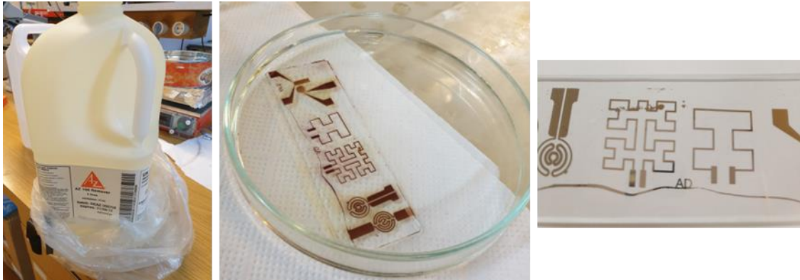
Figura 35: Processo de remoção da resina fotossensível.
