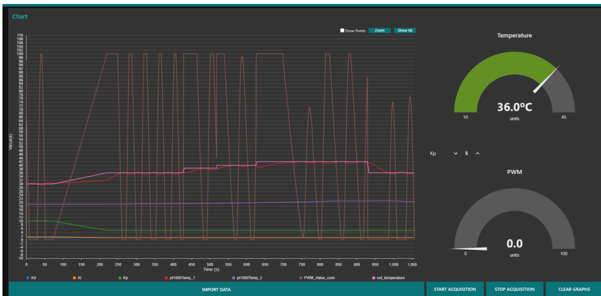
Figura 52: Interface gráfica Cube Monitor com atuação do controlo PID analisando a temperatura no decorrer do tempo e PWM.
