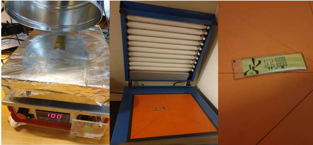
Figura 31: a) Cura da resina fotossensível numa placa de aquecimento. b) Equipamento de exposição UV. c) Máscara de fotolito alinhada sobre a resina fotossensível.
