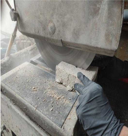
Figura 20 - Corte dos provetes na serra elétrica
