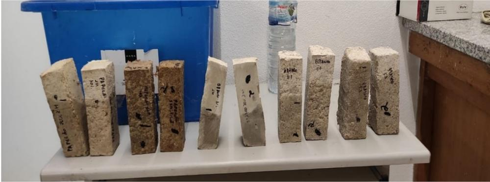
Figura 78 - Capilaridade em todos os provetes após 90 min (6 á esquerda) e 15 min (restantes)
