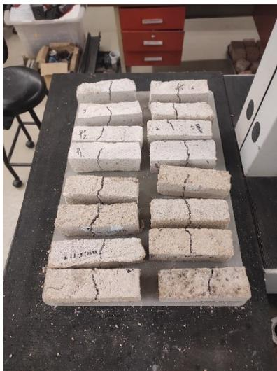
Figura 45 - Provetes após ensaio à flexão
