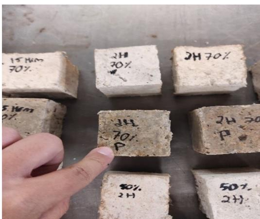
Figura 53 - Diferença entre os provetes com e sem película nos provetes de 70%
