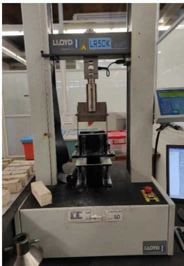
Figura 44 - Máquina Lloyd equipada para a realização de ensaios à flexão
