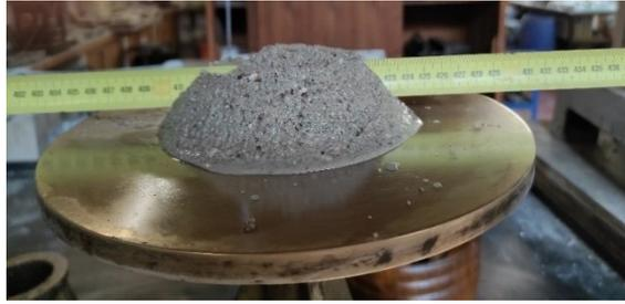
Figura 31 - Medição do espalhamento do provete
