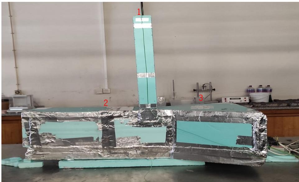
Figura 49 - Prototherm (1-Temperatura ambiente / 2-Temperatura output / 3-Temperatura input)
