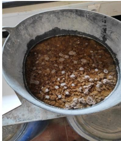
Figura 11 - Resíduo de papel *kraft* totalmente saturado e imerso em água
