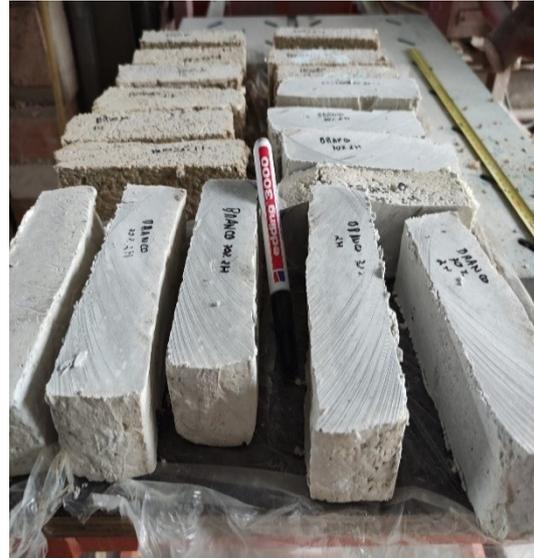
Figura 21 - Provetes após serem cortados
