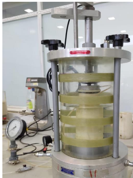
Figura 40- Câmara triaxial a ser preenchida com água
