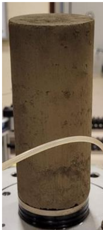
Figura 51- Provete melhorado através da ativação alcalina
