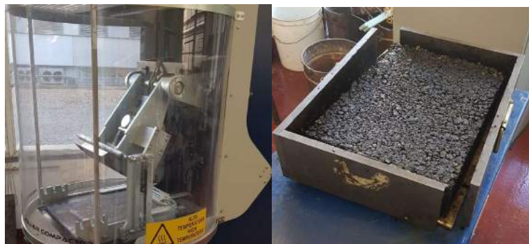
Figura 3-8 – Compactadora mecânica (esquerda) e laje sendo retirada do molde após compactação
