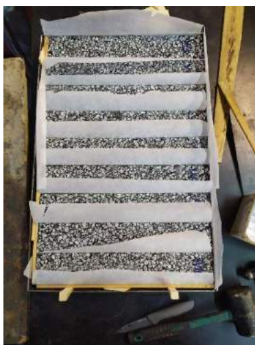
Figura 3-10 – Vigas preparadas para serem aquecidas em conjunto ( combo beams )
