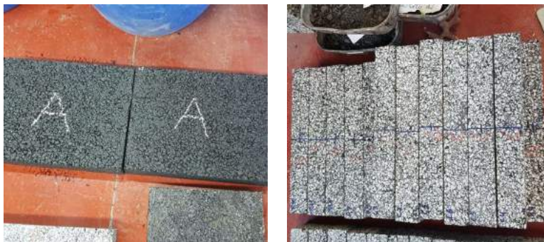
Figura 3-9 – Lajes arrefecidas e identificadas (esquerda) e vigas resultantes da serragem
