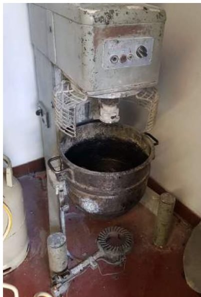
Figura 3-7 – Misturadora de agregados com betume
