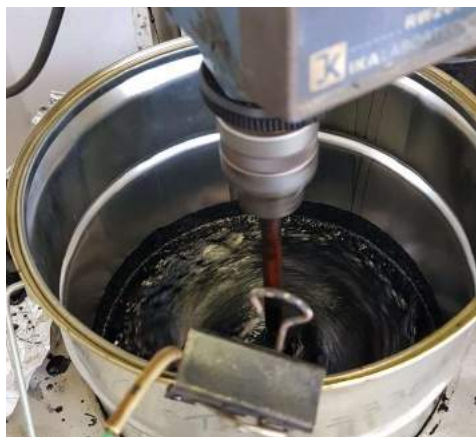
Figura 3-6 – Betume e borracha em fase de digestão (mistura)
