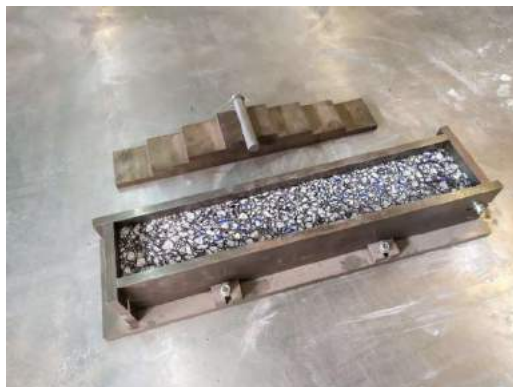
Figura 3-11 – Viga isolada em molde metálico para ser aquecida e compactada ( isolated beam )
