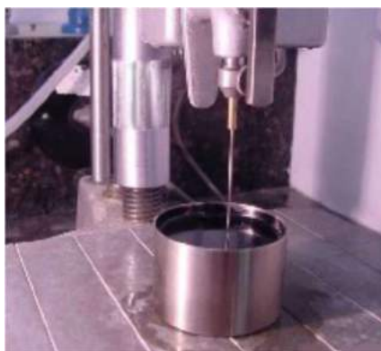
Figura 3-1 – Ensaio de penetração (LECSTP; LNEC, 2013)
