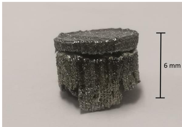
Figura 49 - Amostras com interface plana e visível delaminação e separação.
