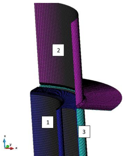
Figura 5.14 – Posição inicial das ferramentas para a Etapa 1: 1) Punção; 2) Matriz; 3) Cerra-chapas.
