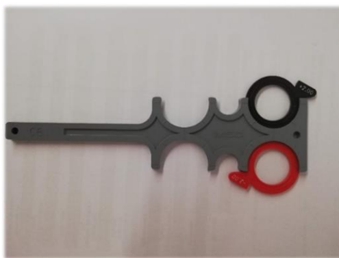
Figura 2.4. Flippers com lentes de \pm 2,00 D para visão de perto.
