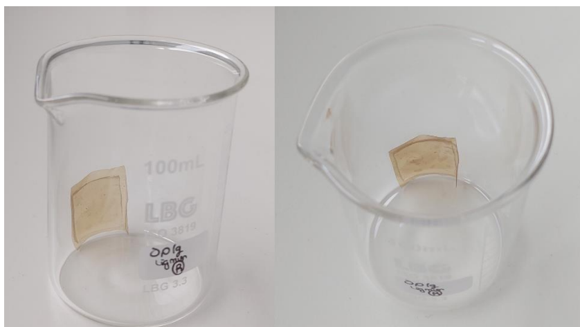
Figura 4.8. Visão frontal (esquerda) e superior (direita) da membrana colocada no interior do gobelé para ensaios de remoção de Cr(VI).
