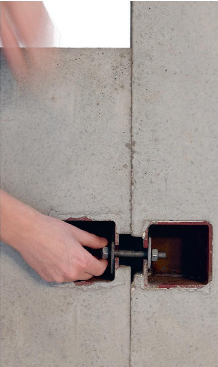
**Figura 3.11.** Protótipo para uma ligação mecânica em elementos estruturais de betão. Martin Ravnsbæk e Hans Nicolai Søndergaard, VIA university college, 2015.
