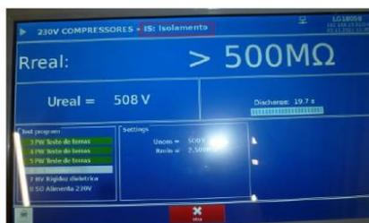
Figura 9 – Resultado positivo no teste de Isolamento.
