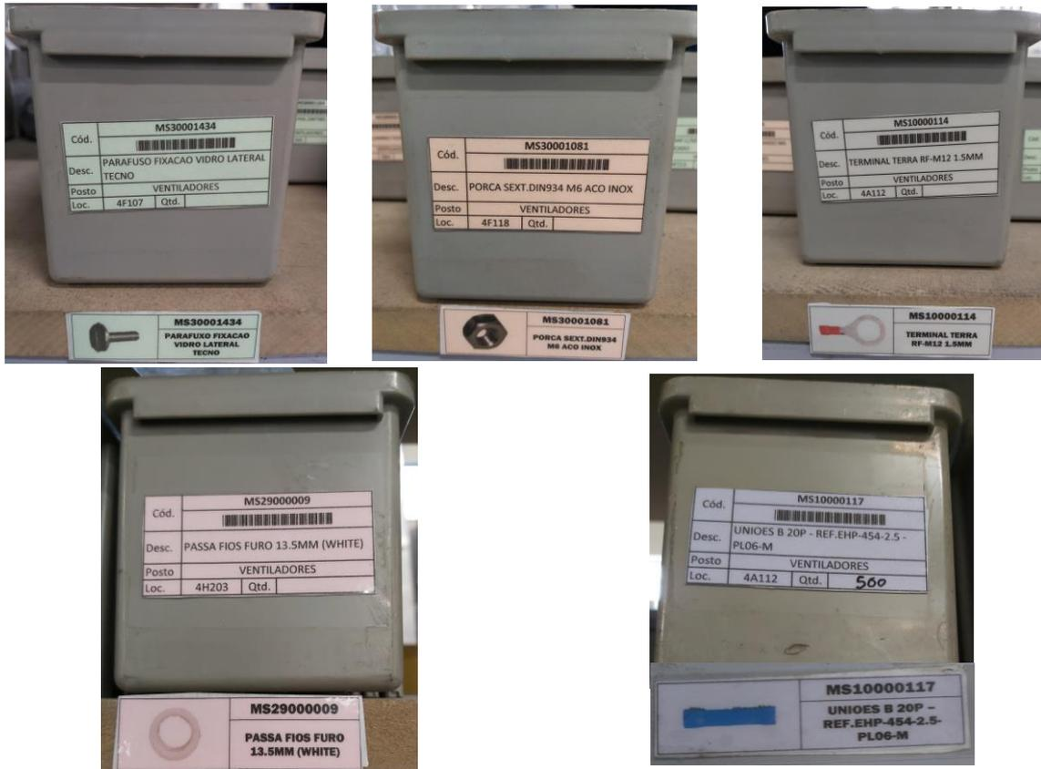
Figura 37 - Etiquetas de identificação de material kanban.
