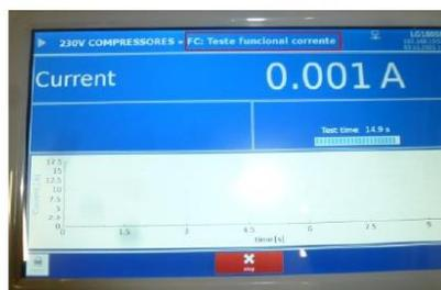
Figura 11 – Durante o ensaio de funcionamento é registrado o consumo (A) da unidade condensadora.
