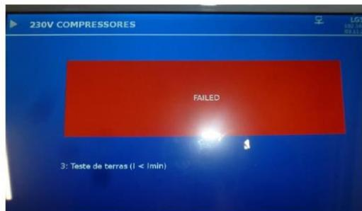
Figura 13 – Mensagem de falha durante um ensaio.
