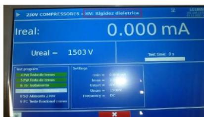
Figura 10 - Resultado positivo no teste de Rigidez Dielétrica.
