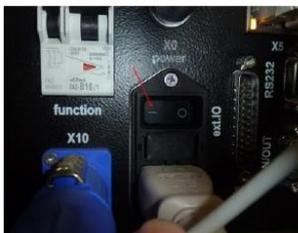
Figura 2 – Interruptor de ligação da máquina de testes.
