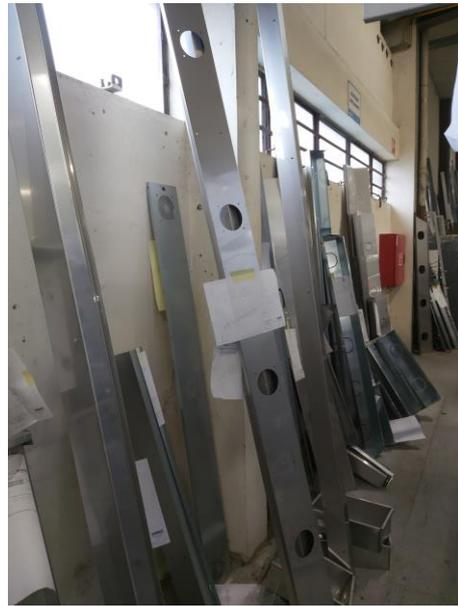
Figura 25 - Corredor de circulação de emergência "antes" dos 5'S.
