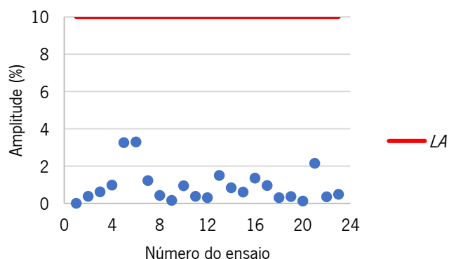
Figura 21. Cartas de aceitação de duplicados (LA - 10 %), tendo como objetivo a monitorização do controlo de qualidade do método para cada cátion: A) Na + ; B) NH 4 + ; C) K + ; D) Mg 2+ ; E) Ca 2+ .
