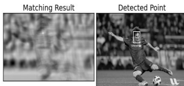
Figura 18: Fórmula de cálculo e Resultado do método CV_TM_CCORR_NORMED [8]
