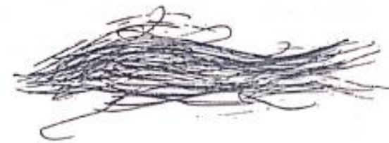
Figura 2.3 - Exemplo de fio de volume elevado [5]
