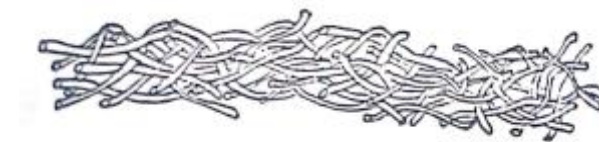
Figura 2.1 - Exemplo de fio de fibras torcidas [5]
