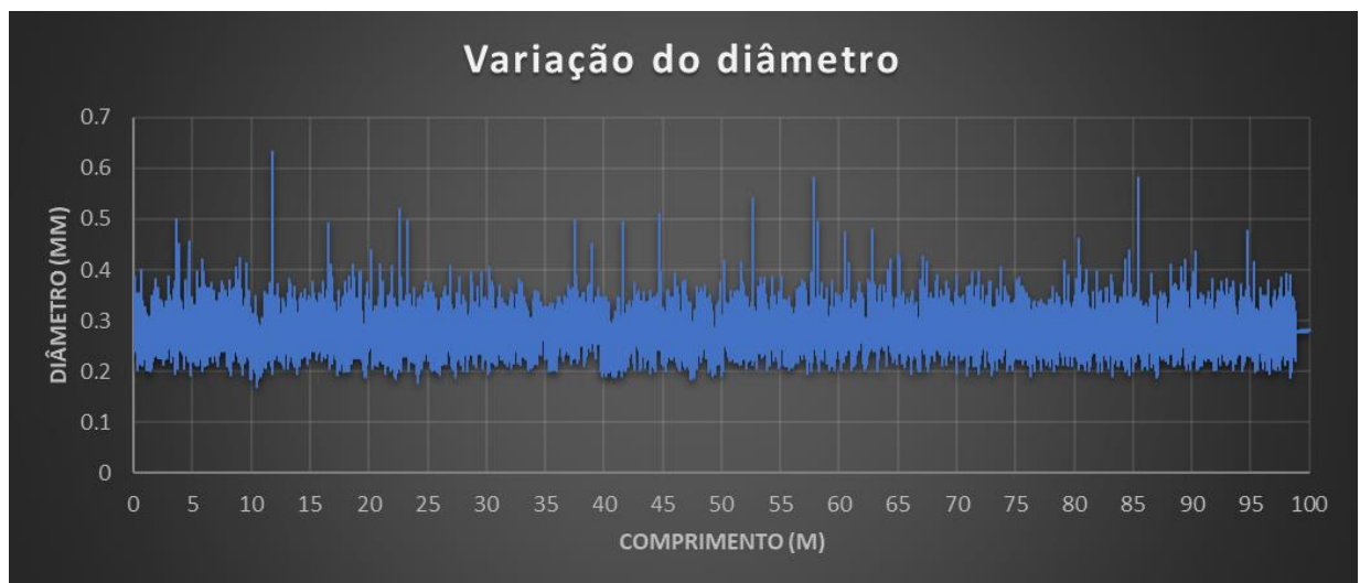
Figura 5.6 - Variação de diâmetro de fio de algodão roxo (100 metros)
