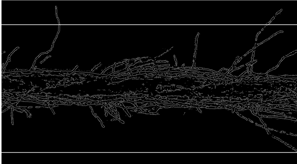
Figura 5.30 - Exemplo 2 de detecção de fibras soltas em fio roxo de algodão
