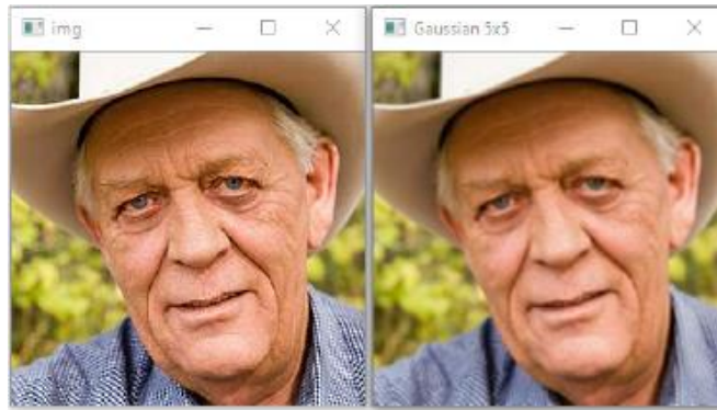
Figura 2.33 - Aplicação de um filtro Gaussiano [19]
