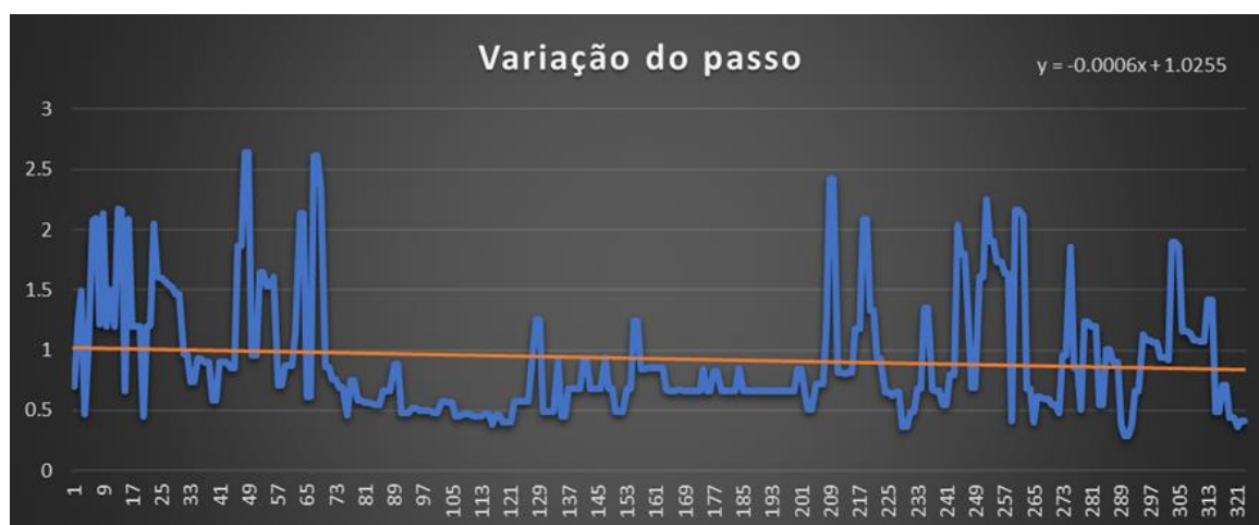
Figura 5.27 - Variação do passo de torção para o fio de algodão roxo (6 metros)
