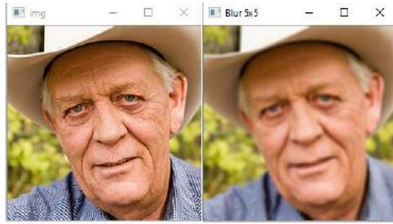
Figura 2.28 - Exemplo de aplicação de um filtro linear para desfocar [19]
