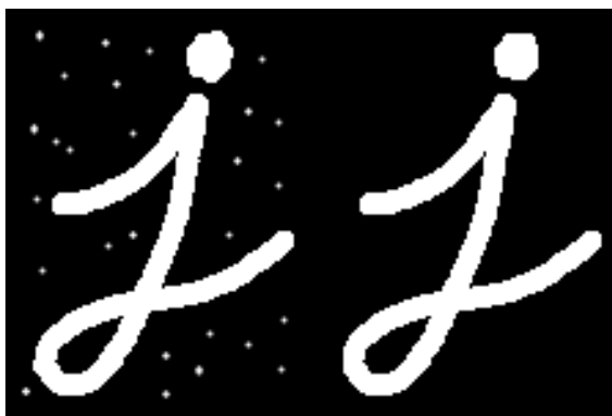
Figura 2.44 - Exemplo de processo de abertura [28]
