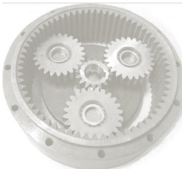
Figura 2.7-Esquema de um trem epicicloidal[5]
