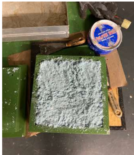
Figura 21 - inserção do resíduo do tipo B no molde [fonte: autor]
