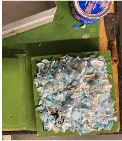
Figura 20 - inserção do resíduo do tipo A no molde [fonte: autor]
