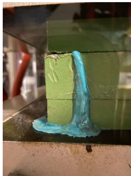
Figura 27 - polímero que escorreu para fora do molde [fonte: autor]
