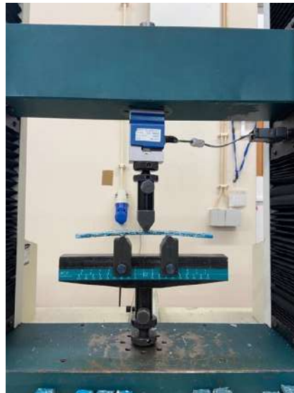
Figura 31 - ensaio de resistência à flexão [fonte: autor]
