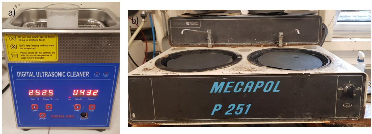
Figura 24 - Equipamento ultrassónico (a) para agitar a mistura e máquina de polimento usada (b).
