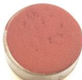
Figura 29 - Deposição de cobre sobre uma amostra texturizada através do uso de uma máscara.
