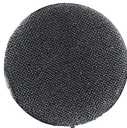
Figura 58 - Amostra texturizada com 20 passagens com deposição de alumina por EPD.
