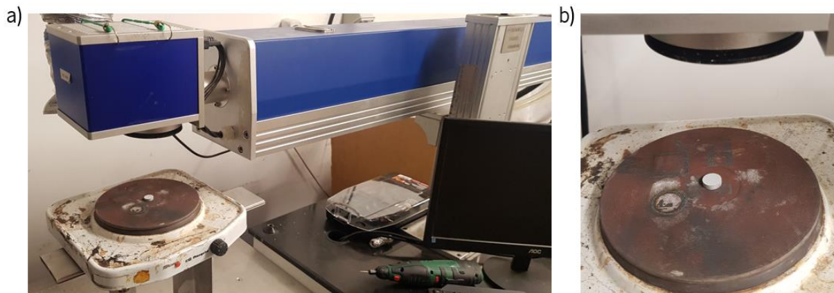
Figura 26 - Fusão seletiva da camada de óxido no laser CO 2 (a) e a amostra sobre a placa de aquecimento (b).
