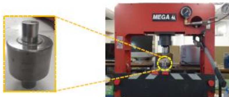
Figura 14 - Matriz de compactação e prensa hidráulica para a compactação dos pós.
