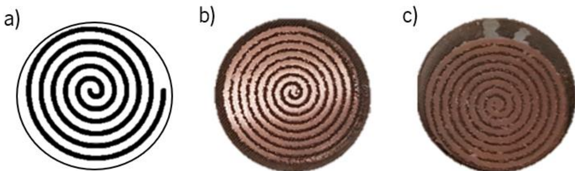
Figura 31 - Trajetória do laser em espiral(a) utilizada para a fusão seletiva laser do cobre e as amostras obtidas com velocidade 10 mm/s (b) e 5 mm/s (c).
