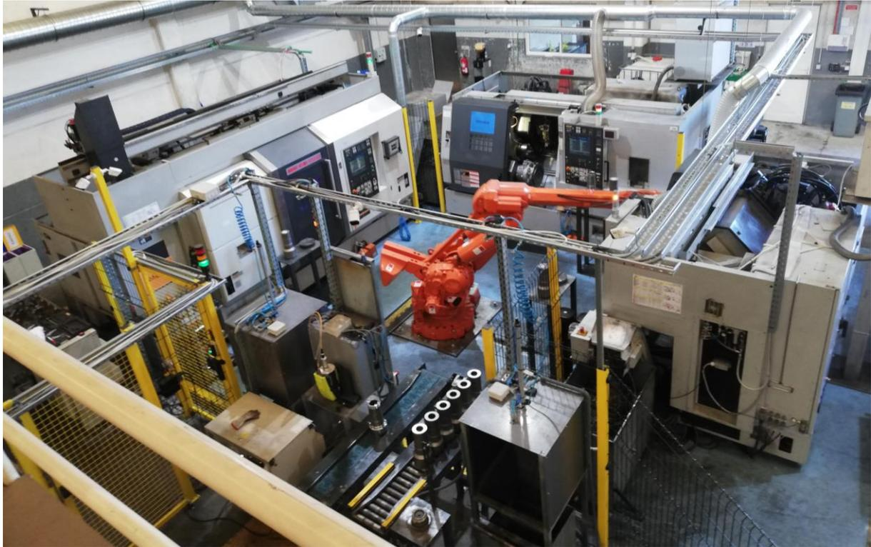
Figura 30 – Robot a colocar peça dentro de um dos tornos (JASIL, 2022)
