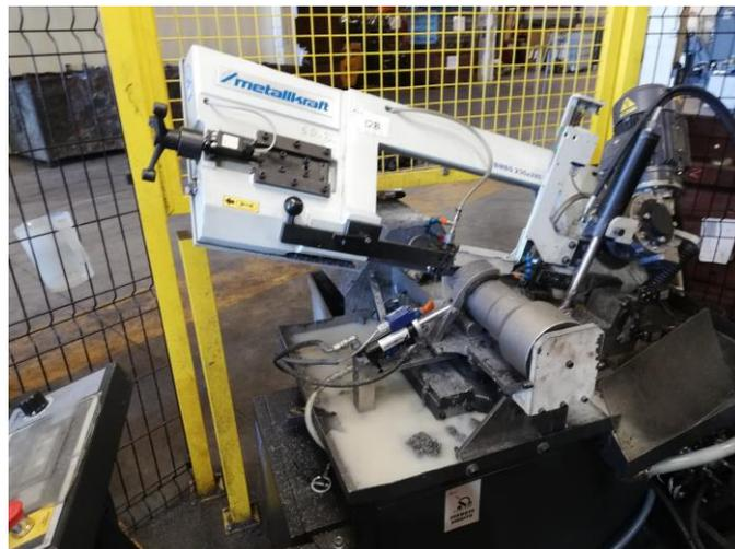
Figura 29 - Serrote de fita automático (JASIL, 2022)
