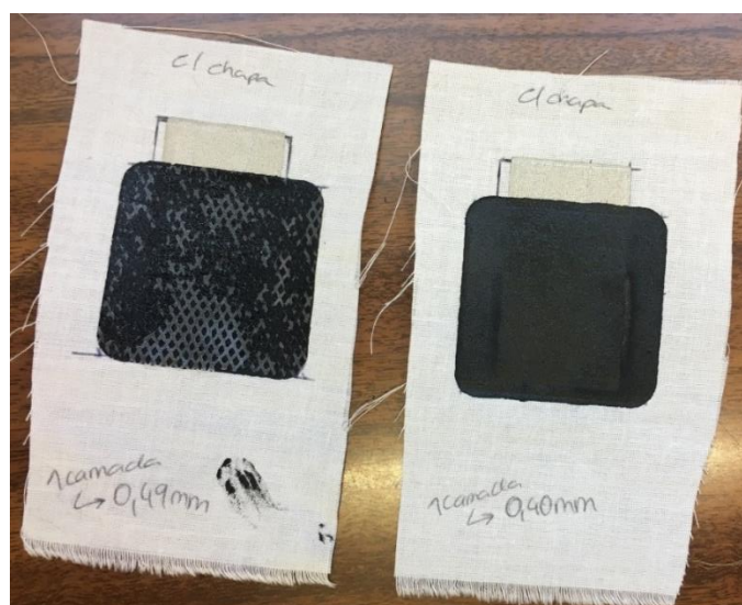
Figura 96. Sensor descolado com a rede termoplástica visível numa das faces
