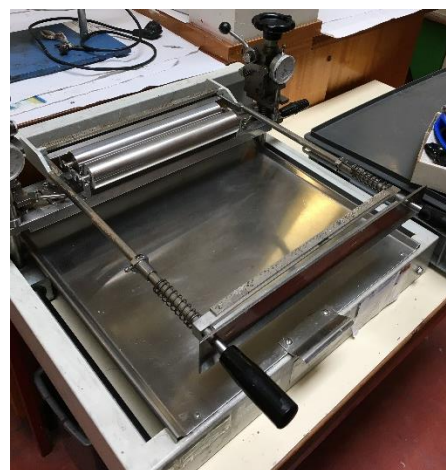
Figura 21. Técnica de coating com faca (esquerda) (Shim, 2019) e equipamento de coating Mathis CH-8155, presente no laboratório (direita)
