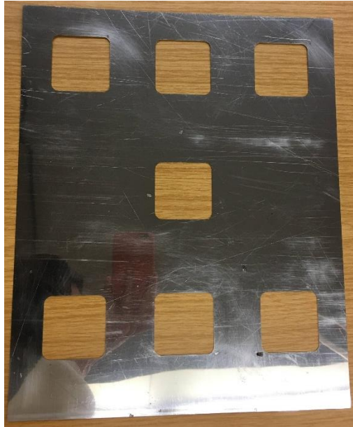
Figura 52. Chapa com espessura de 0,60 mm utilizada para estampar a tinta piezoresistiva
