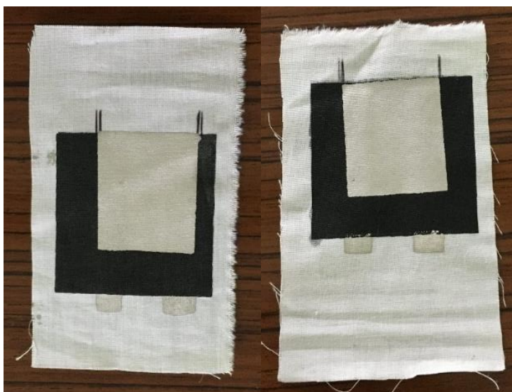
Figura 76. Elérodos estampados do lado oposto da tinta piezoresistiva curados a 80 e a 120°C, respetivamente
