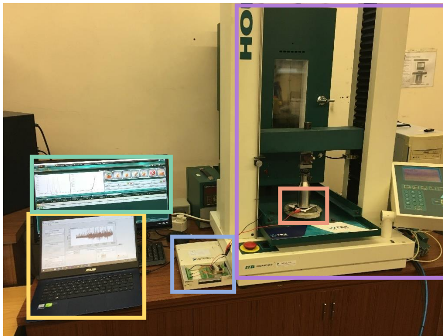
Figura 24. Configuração do teste de compressão cíclica. Computador com software de aquisição do sinal (amarelo), computador para configuração e aquisição da força (verde), DAQ (azul), máquina de teste Hounsfield (roxo), sensor (rosa)
