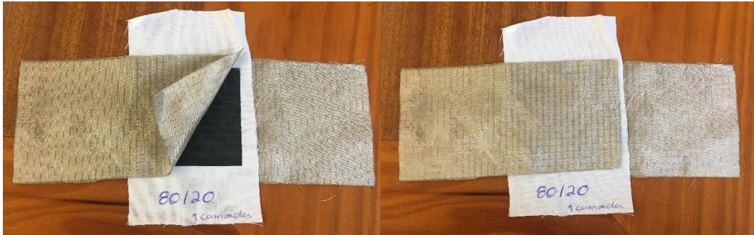
Figura 38. Sensor com elétrodos de tecido condutor e tinta piezoresistiva com 20% de aditivo
