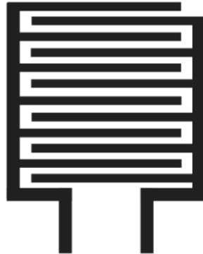
Figura 60. Desenho dos eletrodos interdigitados com 2 mm de espaçamento entre linhas, linhas horizontais com 2 mm de espessura e linhas verticais com 3 mm de espessura
