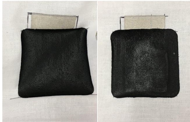
Figura 54. Faces do sensor estampado com uma camada de tinta condutora e uma camada de tinta piezoresistiva usando a chapa metálica
