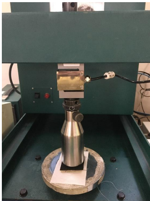
Figura 28. Haste transversal móvel com uma célula de força de 2.5 kN, um punção de compressão (em cima), placa fixa (em baixo)
