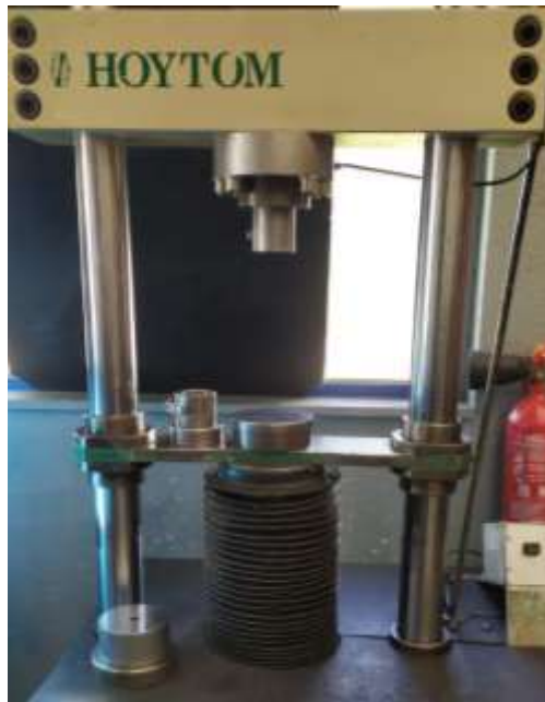
Figura 23: Máquina na qual se realizam os ensaios destrutivos da referência em estudo.
