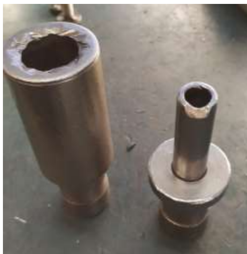
Figura 12: Tubo (à esquerda) e punção (à direita) utilizados no ensaio de tração da referência em estudo.
