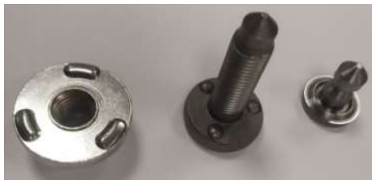
Figura 10: Componentes para soldadura por resistência com diferentes geometrias de protuberâncias (da esquerda para a direita: peça com protuberâncias oblongas, peça com protuberâncias semicirculares e peça com protuberância anelar).
