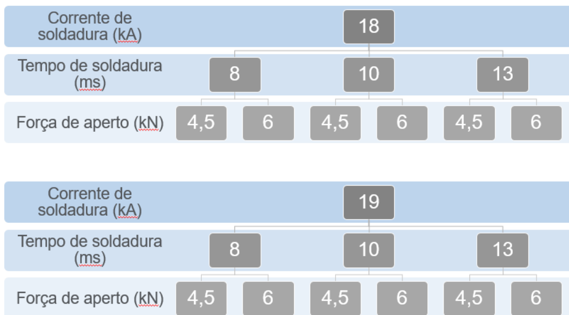
Figura 15: Conjunto de experiências planificadas de modo a averiguar a melhor combinação de parâmetros para o processo modificado.
