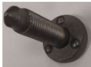
Figura 11: Parafuso soldado por resistência no processo em estudo.
