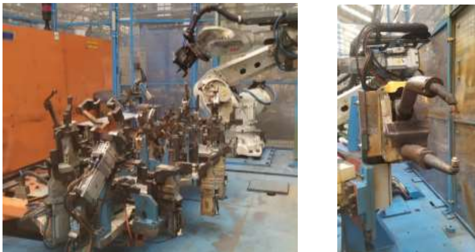
Figura 8: Exemplo de robôs de soldadura para soldadura por pontos.
