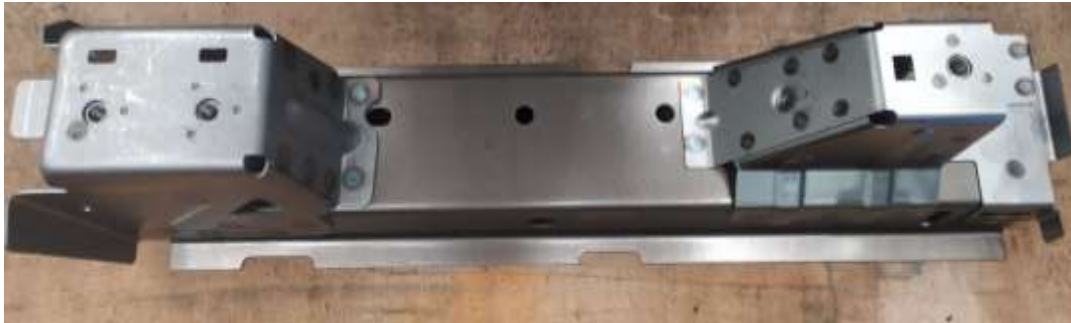
Figura 9: Peça com pontos de soldadura efetuados no robô de soldadura representado na figura 5.
