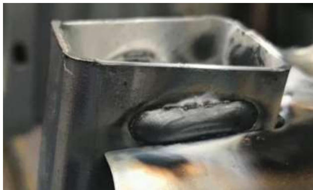
Figura 5: Exemplo de cordão de soldadura deslocado devido a materiais diferentes.
