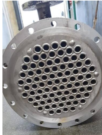
Figura 37 - Vista interior do PC tubular HE-32
