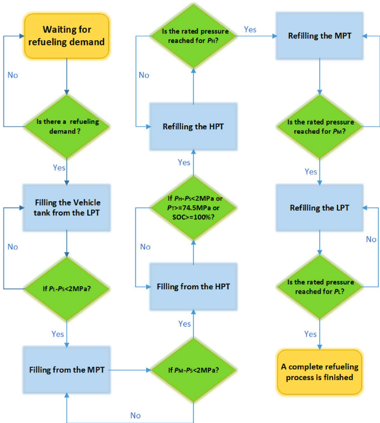
Figura 31 - Esquema do processo de abastecimento em cascata [41]
