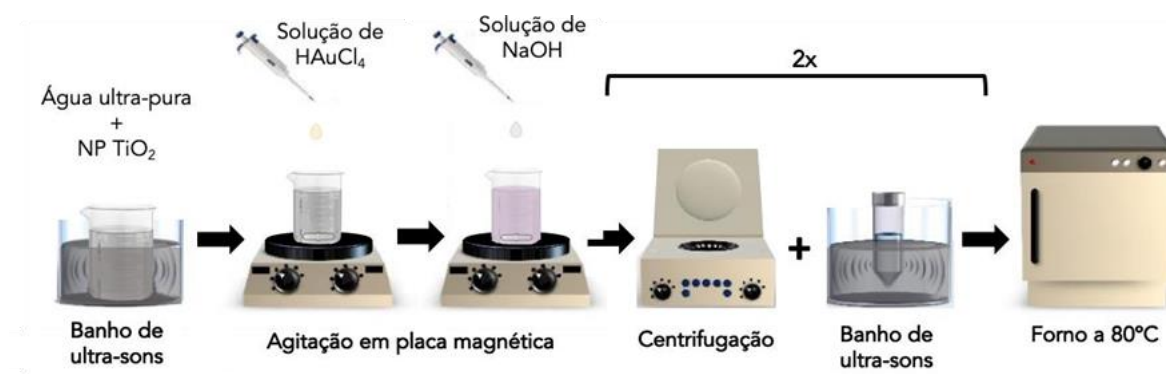
Figura 11 – Esquema representativo do método de síntese das nanopartículas de Au/ \text{TiO}_2 [61].
