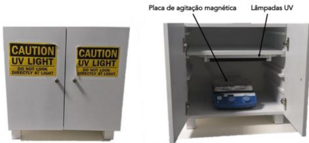
Figura 21 – Fotoreator utilizado para testes de degradação de NOR com radiação UV [61].
