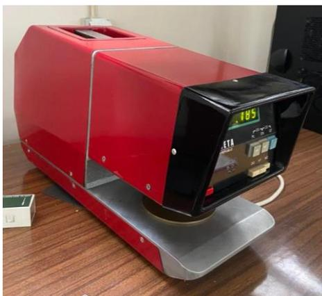
Figura 48 - Alambeta - Equipamento utilizado para determinar as propriedades termofisiológicas, Universidade do Minho
