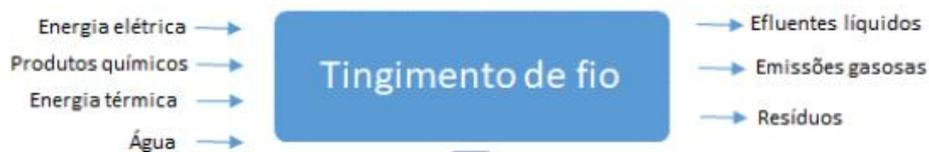
Figura 25 - Entradas e saídas do processo de tingimento do fio, acervo do autor
