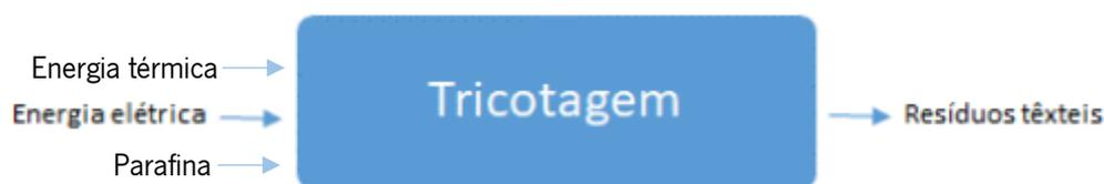
Figura 28 - Entradas e saídas no processo de tricotagem, acervo do autor
