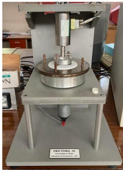
Figura 46 - Frictorq-01 – equipamento de medição, Universidade do Minho
