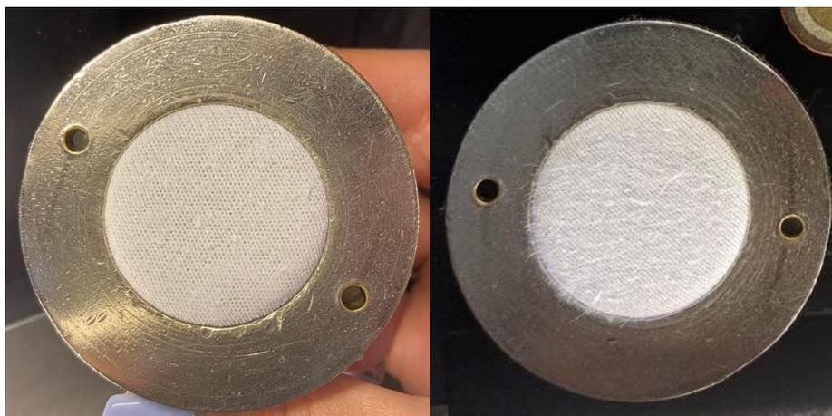
Figura 44 - Resultados obtidos do ensaio da resistência à formação de borboto após 5000 ciclos para a malha 60%CO reciclado 40%CO convencional, acervo do autor
