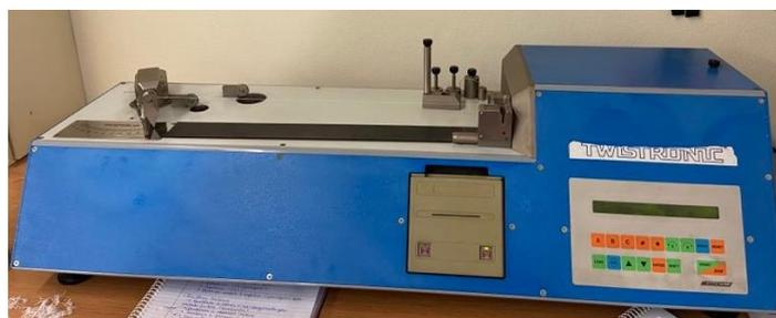
Figura 43 - Torciómetro – aparelho utilizado, Universidade do Minho
