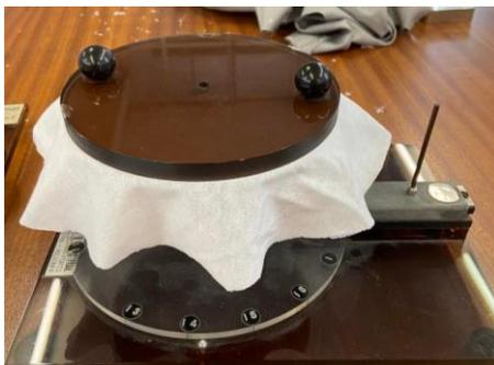
Figura 51 - Drapeómetro - Aparelho de medição do drapé, Universidade do Minho
