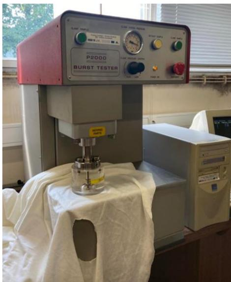
Figura 47 - Eclatómetro – Burst Tester, Universidade do Minho
