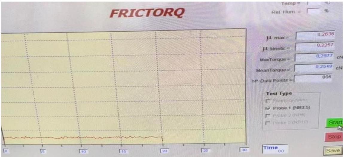
Figura 60 - Gráfico obtido no ensaio do coeficiente de atrito cinético para a malha convencional (quinto teste), acervo do autor
