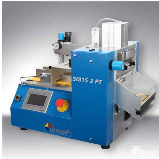
Figura 1 - Máquina de corte universal da Ulmer [2]
