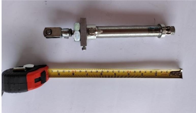
*Figura 75 - Cilindro pneumático utilizado na construção*
