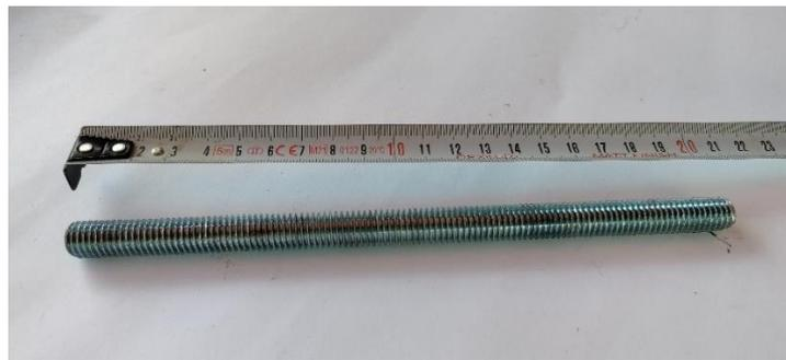
*Figura 64 - Veio das polias utilizado na construção*
