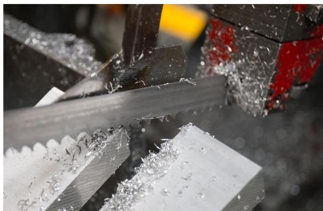
*Figura 7 - Exemplo de corte de serra de fita [14]*
