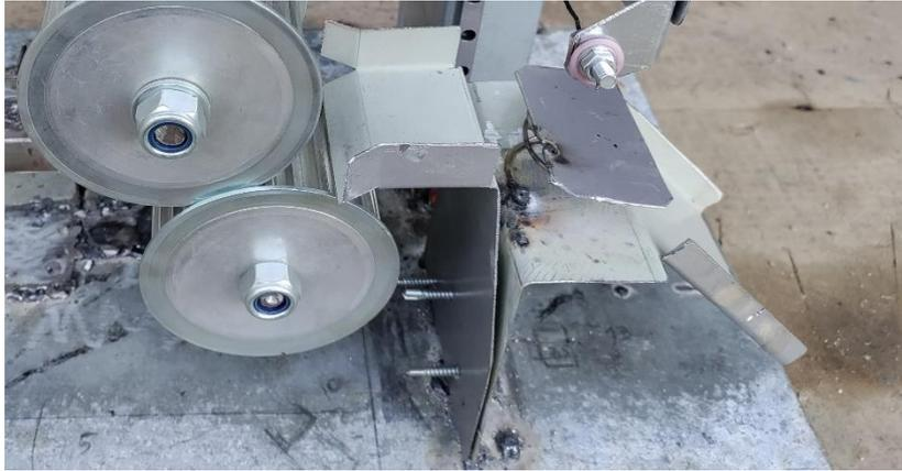
*Figura 80 - Suportes aplicados na máquina*
