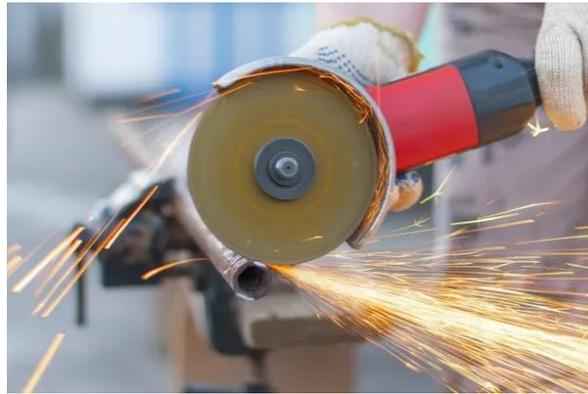
*Figura 6 - Exemplo de corte abrasivo [13]*
