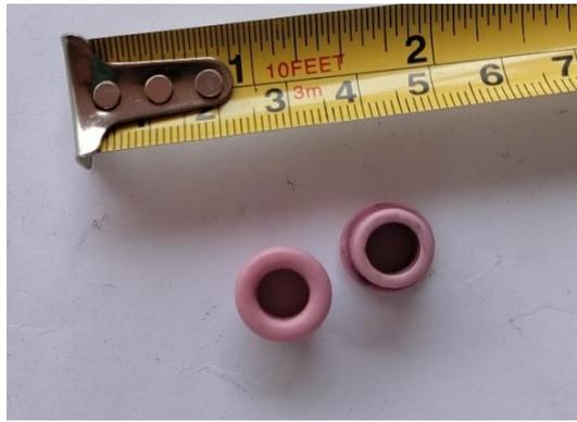
*Figura 77 - Isolantes cerâmicos utilizados na construção*
