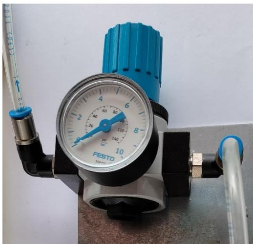
*Figura 81 - Regulador de pressão utilizado na máquina*
