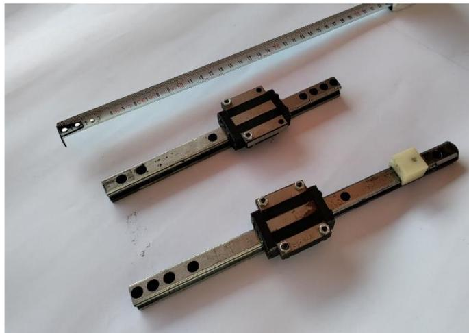
*Figura 67 - Guias lineares utilizados na construção*
