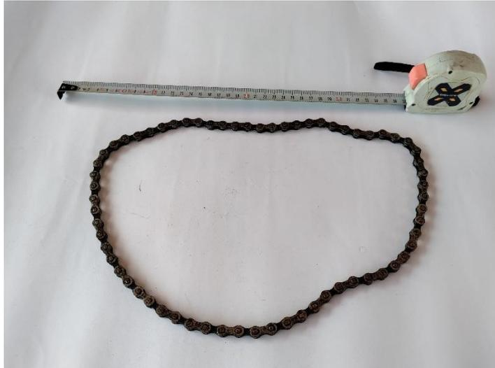
*Figura 69 - Corrente de transmissão utilizada na construção*
