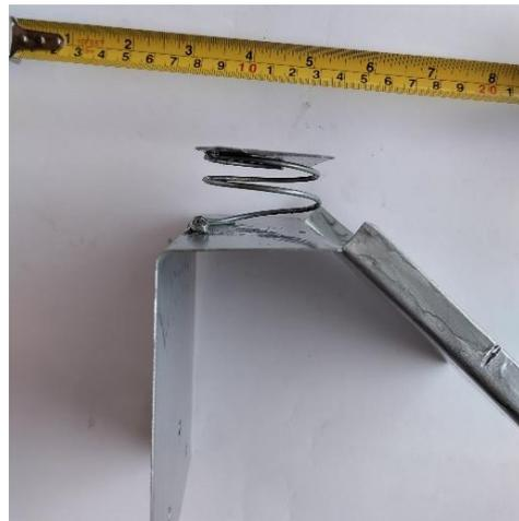
*Figura 79 - Suporte para corte do tubo*
