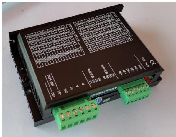
Figura 85 - Controlador do motor utilizado na máquina
