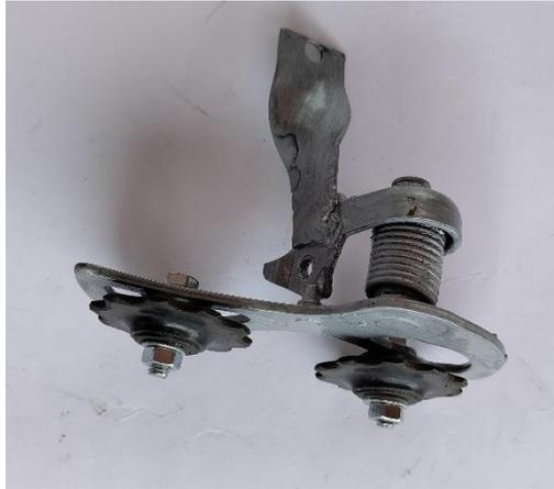
Figura 72 - Esticador de corrente utilizado na construção
