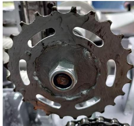
*Figura 71 - 1 dos pinhões tracionados acoplados às correias*
