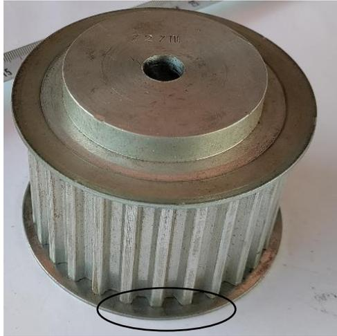
Figura 68 – Pormenor da polia utilizada na construção
