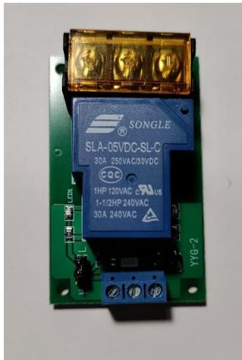
Figura 87 - Relé utilizado na máquina
