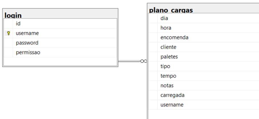
Figura 41 – Diagrama da base de dados de suporte ao plano de cargas
