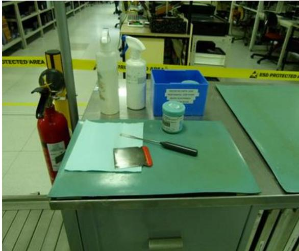
Figura 20: Antes da bancada de suporte à preparação das máscaras da EKRA. Fonte: Empresa.
