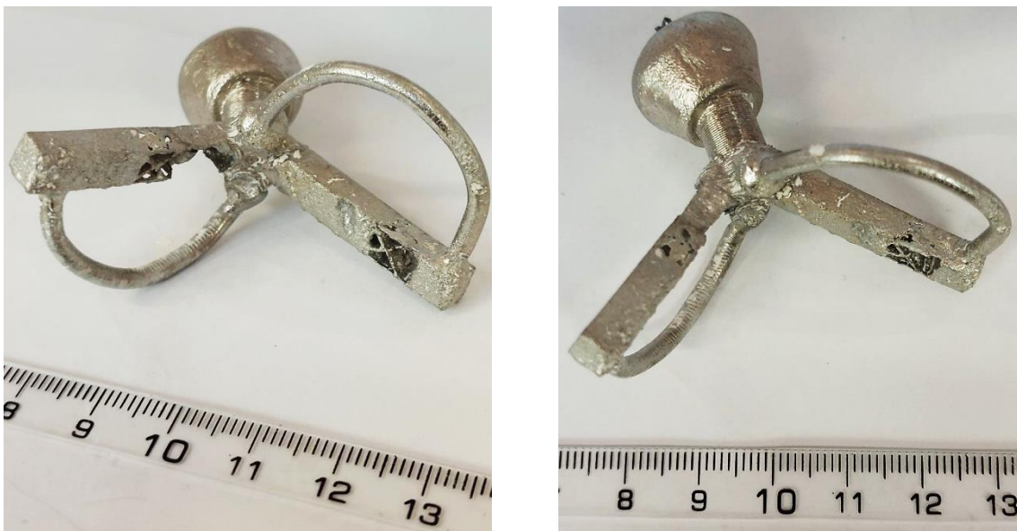
Figura 4.67 - Ângulos diferentes das duas microvigas metálicas otimizadas pelo método modal, com contribuição dos microcanais projetados.
