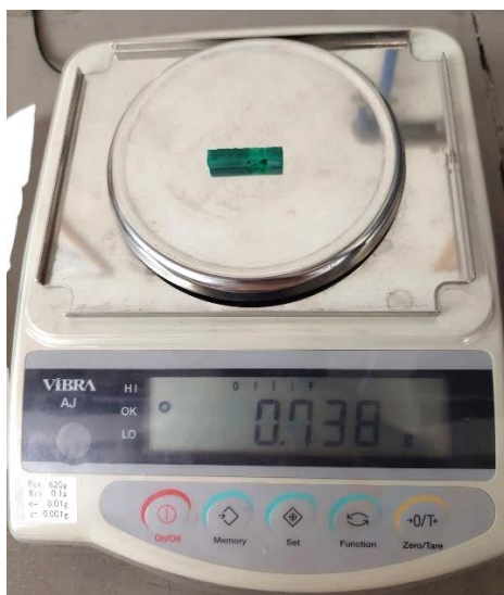
Figura 3.22 - Balança utilizada para proceder à pesagem de cada microviga.
