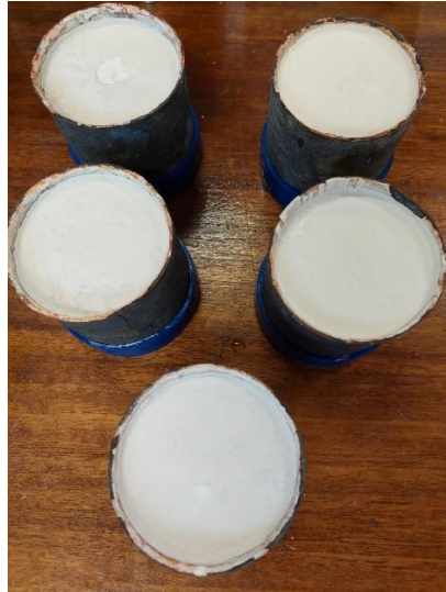
Figura 3.29 - Moldações com o gesso solidificado.
