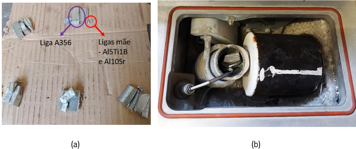
Figura 3.32 – Em (a) encontram-se representadas as 5 amostras, cada uma com 15 g da liga de A356 e ligas mãe (Al5Ti1B e Al10Sr) e, em (b) vista de cima do forno de indução: colocação do cadinho, molde cerâmico e liga A356 e ligas mãe, antes de iniciar processo de fundição.
