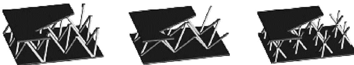
Figura 2.6 - Exemplos de painéis sanduíche com núcleos metálicos celulares periódicos, para o caso com estrutura central tetraédrica, piramidal e 3D kagome , respetivamente [55].
