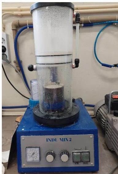
Figura 3.28 - Máquina utilizada para o procedimento da mistura de água e gesso.
