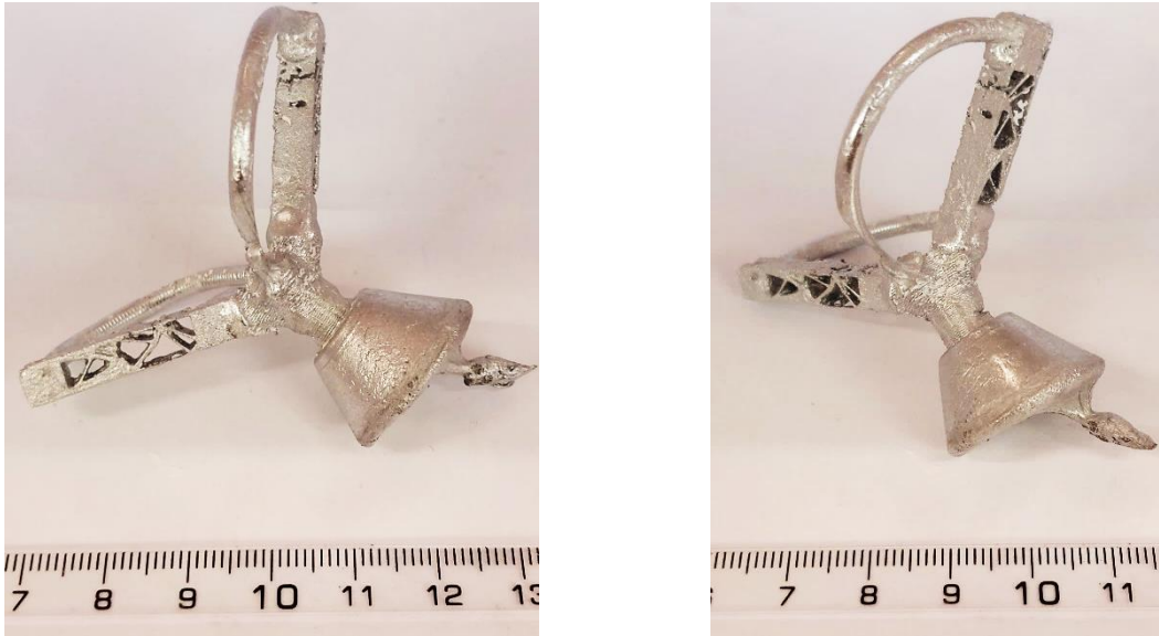
Figura 4.66 - Ângulos diferentes das duas microvigas metálicas otimizadas pelo método estático, com contribuição dos microcanais projetados.
