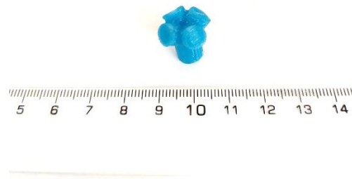
Figura 3.23 - Cacho com 4 ramificações produzido em PLA.
