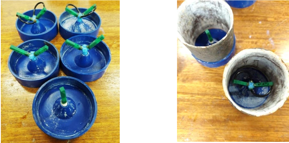
Figura 3.27 - Preparação dos modelos de sacrifício antes da colocação do gesso.
