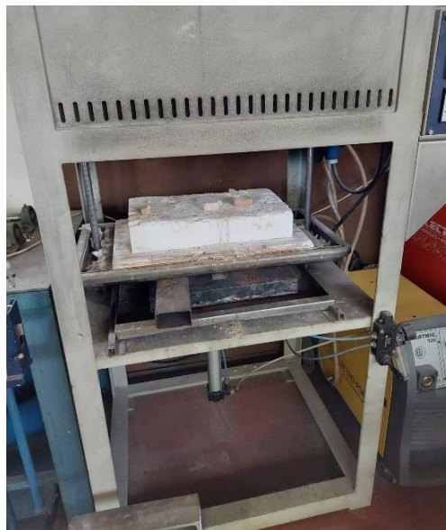
Figura 3.30 - Mufla utilizada para a realização do ciclo térmico do gesso.
