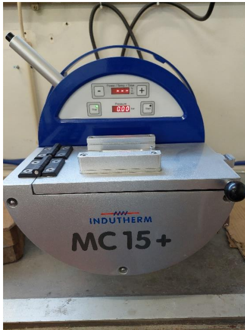
Figura 3.33 - Forno de fundição Indutherm MC15+ .
