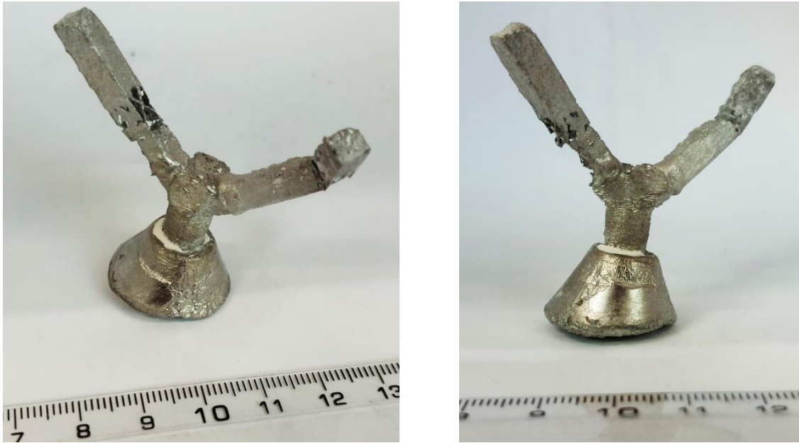
Figura 4.64 - Ângulos diferentes das duas microvigas metálicas otimizadas pelo método modal.
