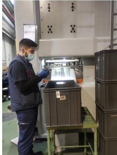
Figura 28-Controlo visual após o processo de estampagem
