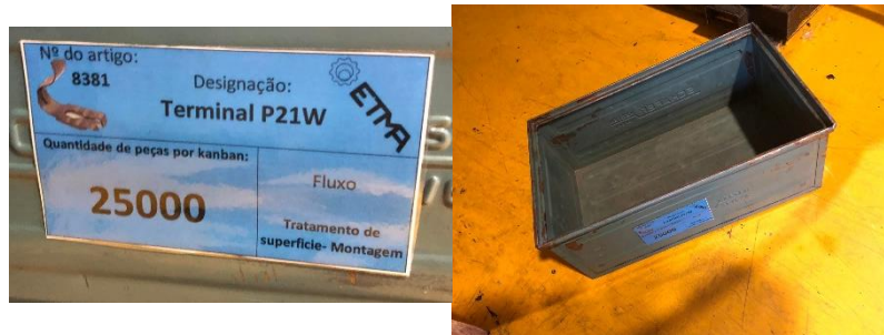
Figura 75- Contentores identificados com cartão kanban
