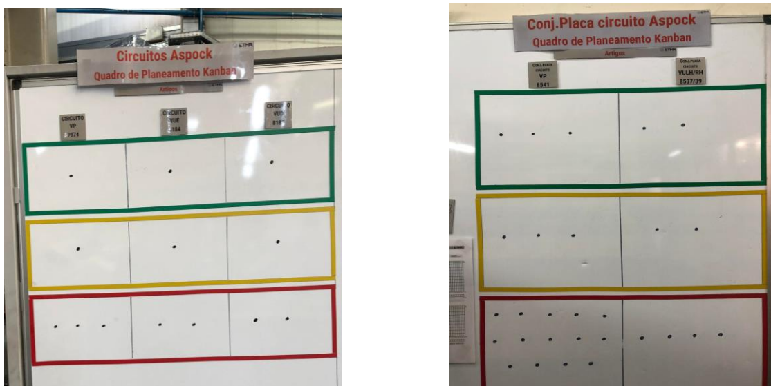
Figura 67-Quadro planeamento Kanban da estampagem e na soldadura
