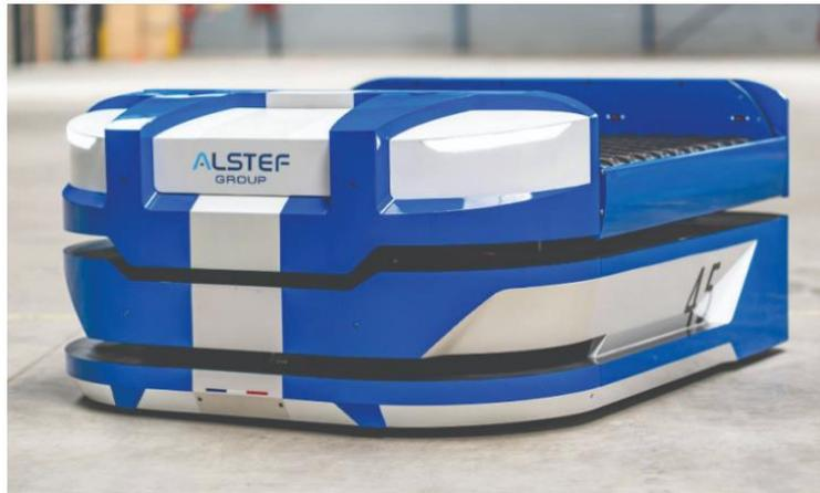
Figura 8 - Exemplo de AGV de carga unitária
