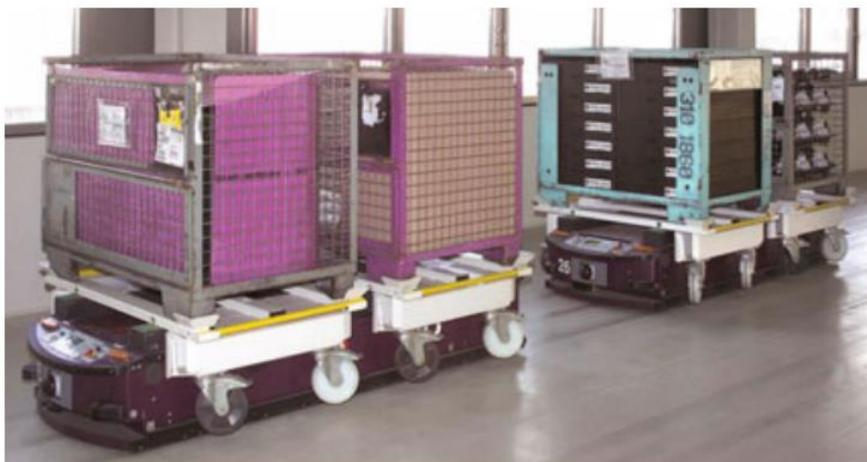
Figura 11 - Exemplo de AGV *Underride*
