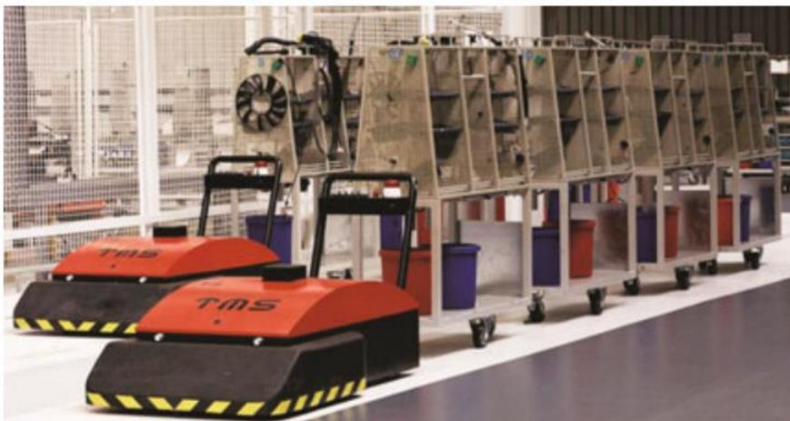
Figura 7 - Exemplo de AGV de reboque
