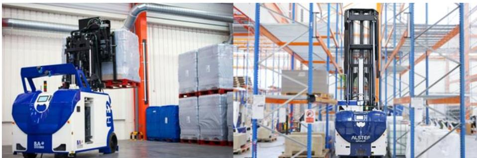
Figura 9 - Exemplo de AGV de empilhador
