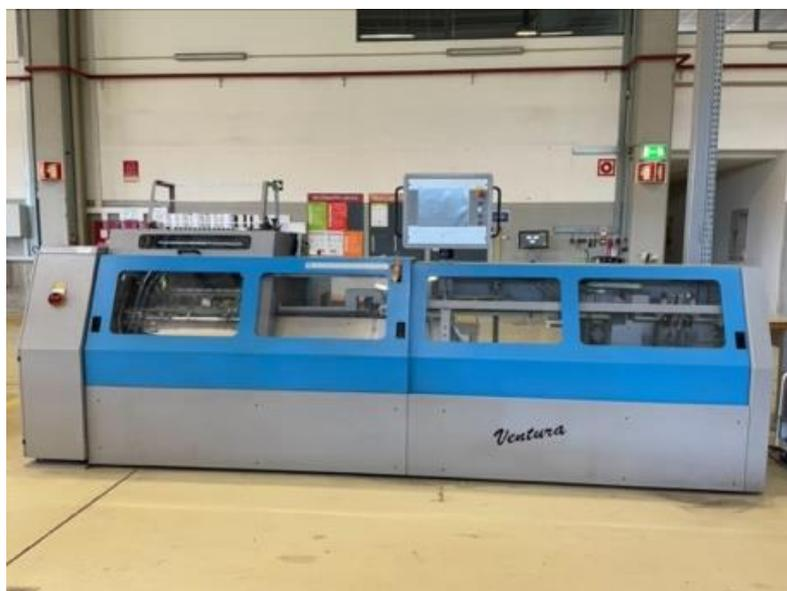
Figura 26 - Máquina de alcear e coser (Ventura)
