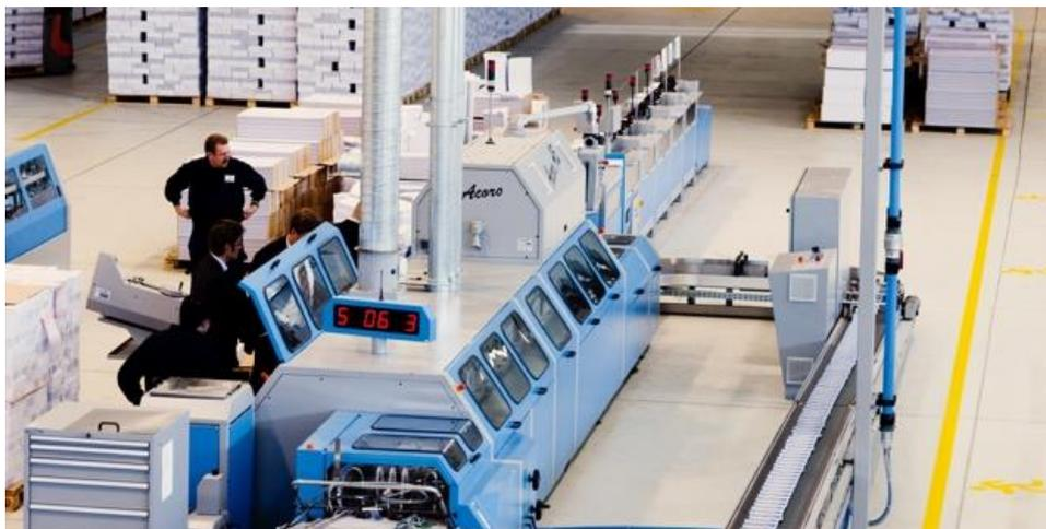
Figura 25 - Máquina de alcear e colar (Acoro)
