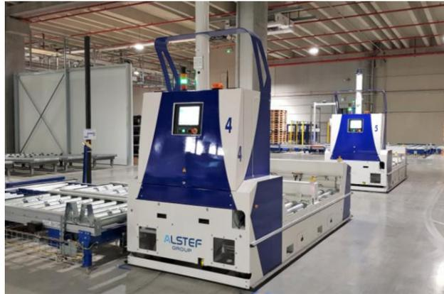
Figura 10 - Exemplo de AGV *piggyback*
