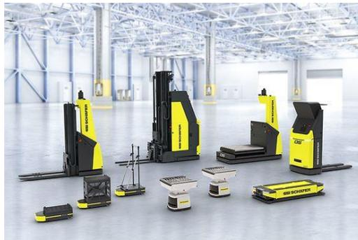
Figura 6 - Exemplos de sistemas de AGVs
