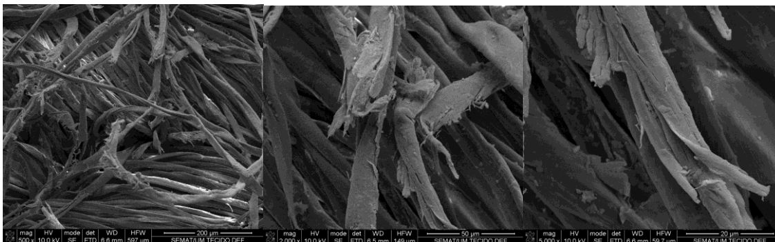
Figura 21. Observação microscópica MEV da zona com defeito mais evidente.
