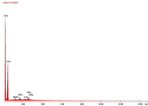
Figura 22. Espectro EDX da malha na zona sem defeito.
