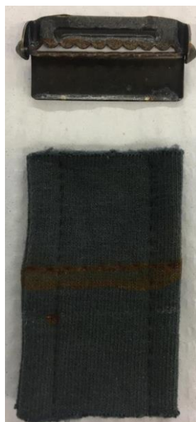
Figura 41. Reprodução do defeito com o suspensório envernizado em solução ácida.
