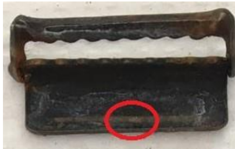
Figura 32. Fotografia do “bucklet” metálico utilizado na reprodução do defeito com solução ácida analisado no MEV.
