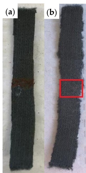
Figura 50. Remoção da mancha com ácido fluorídrico, (a) antes (b) depois.
