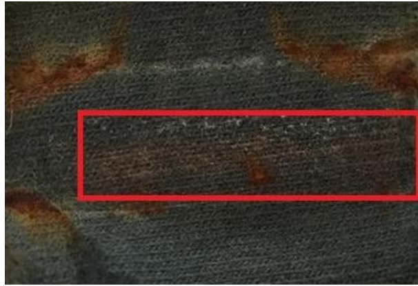
Figura 24. Defeito reproduzido laboratorialmente em solução ácida.
