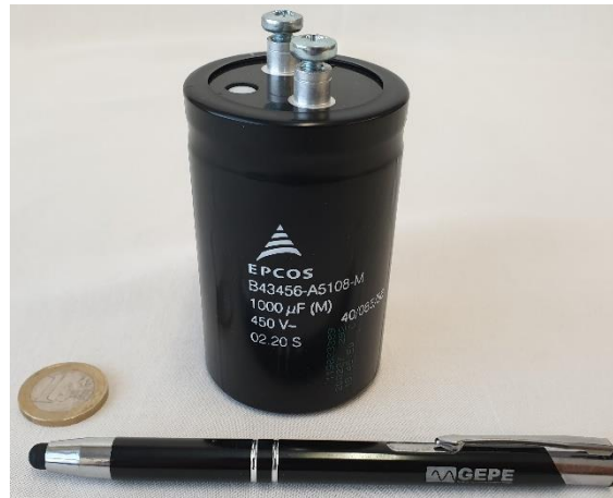
Figura 5.6 - Condensador eletrolítico utilizado no barramento CC.
