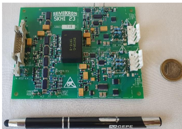
Figura 5.4 - Placa de circuito de driver SKHI 23/12.
