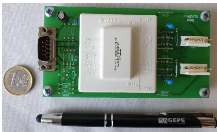
Figura 5.3 - Placa de circuito de driver SKHI22AH4R.
