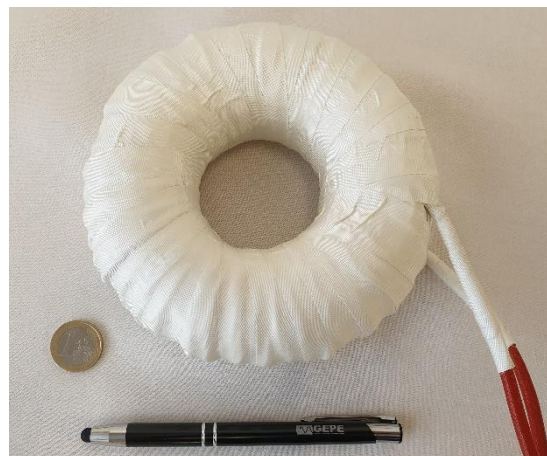
Figura 5.7 - Bobina desenvolvida para o conversor CC-CC do tipo step-up .
