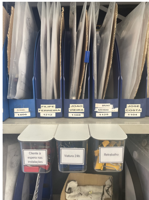
Figura 43: Sistema de molas coloridas para definição de prioridade de veículos em funcionamento
