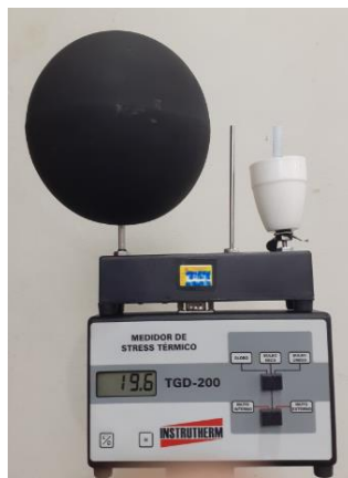
Figura 24: Medidor de stress térmico utilizado em campo
