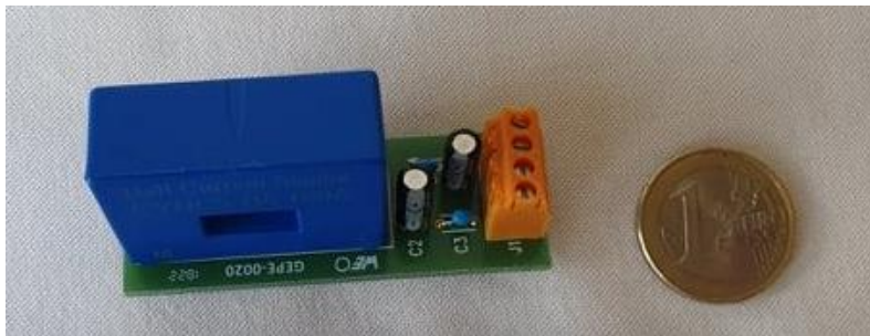
Figura 5.7 - Placa integrada do sensor de corrente LA 100-P.
