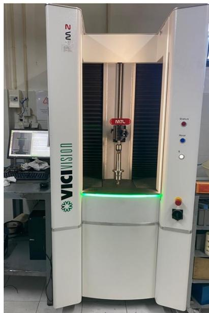
Figura 23 Máquina de medição VICIVISION
