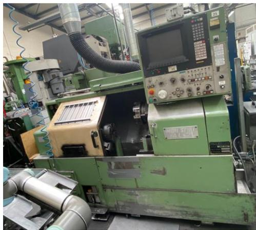
Figura 44 - Torno avariado na secção de torneamento
