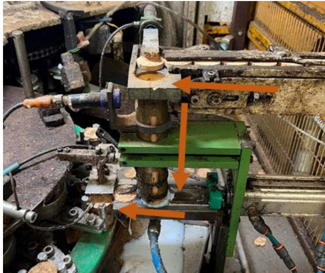
Figura 30- Passagem de discos para a máquina não nivelada
