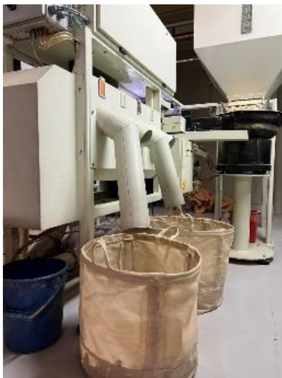
Figura 13- Falta de identificação nas alcofas
