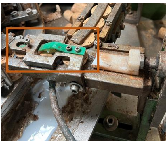
Figura 34- Peça inicial utilizada para pressionar os discos
