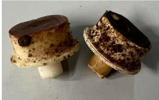
Figura 21- Calcadores defeituosos inutilizáveis
