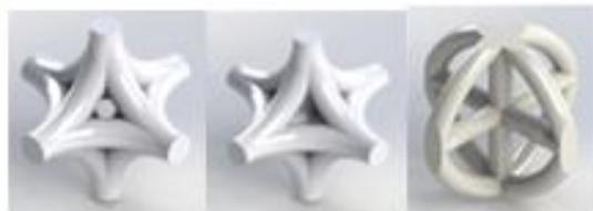
Figura 4.71 - Estruturas com maior valor de rigidez. Da esquerda para a direita: *COMP1\_A*, *COMP1\_C*, e *TORC1\_B*
