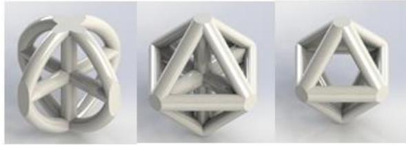
Figura 4.72 - Estruturas com maior valor de energia de deformação. Da esquerda para a direita: *TORC1\_B*, *COMP1\_D*, e *COMP1\_B*
