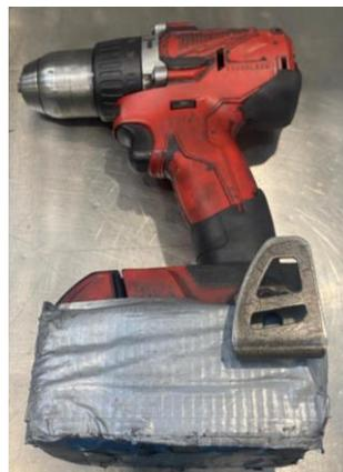
Figura 50 - Aparafusadora elétrica em mau estado
