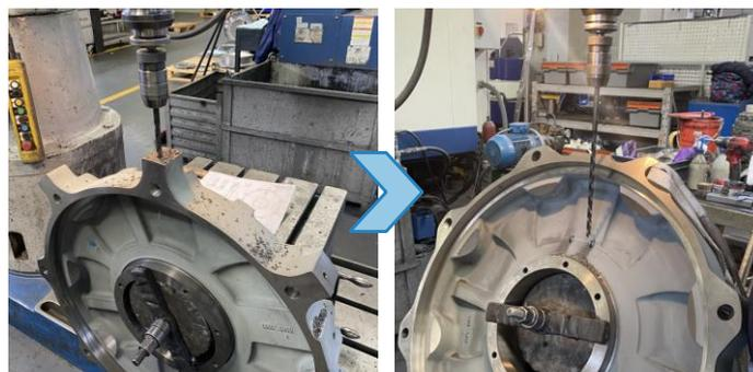
Figura 29 - Furação na vertical (esquerda) e inclinada (direita)
