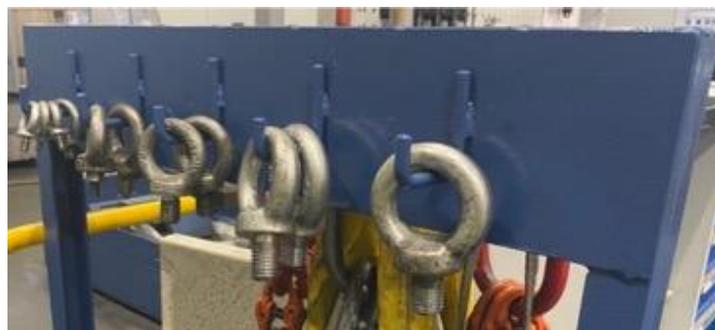
Figura 34 - Falta de identificação dos olhais
