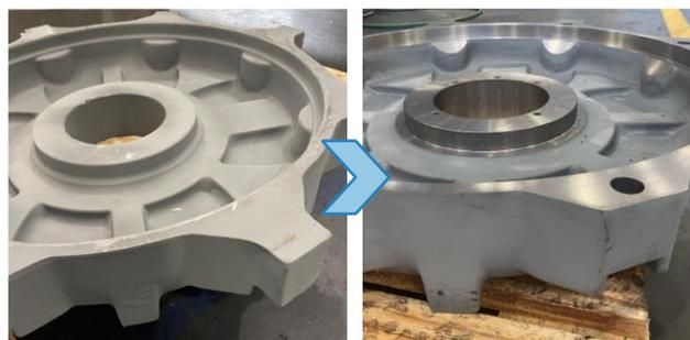
Figura 27 - Tampa em bruto (esquerda) e pré-maquinada (direita)
