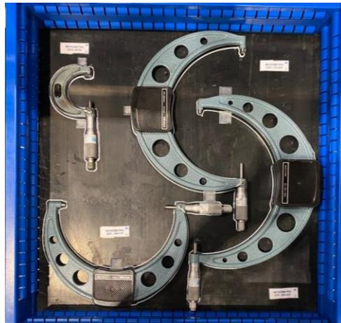
Figura 57 - Gaveta com micrómetros
