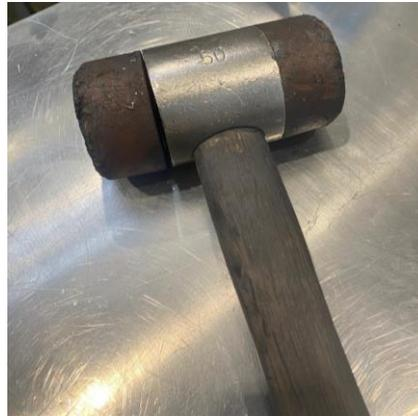
Figura 49 – Martelo de *nylon* em mau estado
