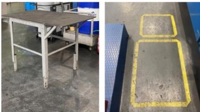
Figura 36 - Marcações no *shop floor* em falta (esquerda) e desatualizadas (direita)
